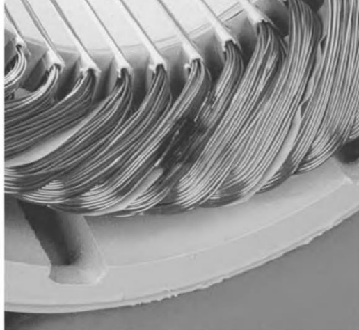
Gambar 6.33 Belitan dengan fase-ke-fase pendek. EASA
