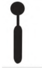
Gambar 5.14 Batang rotor yang digunakan dalam desain rotor C memiliki dua bentuk yang dihubungkan.
