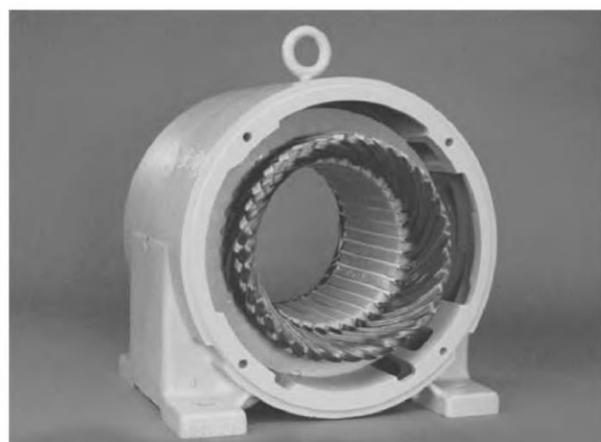
Gambar 6.32 Gulungan stator putaran-putaran. EASA.
