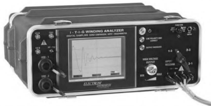
Gambar 8.9 Penguji surja yang mampu membandingkan dan menguji tegangan tegangan putar.
