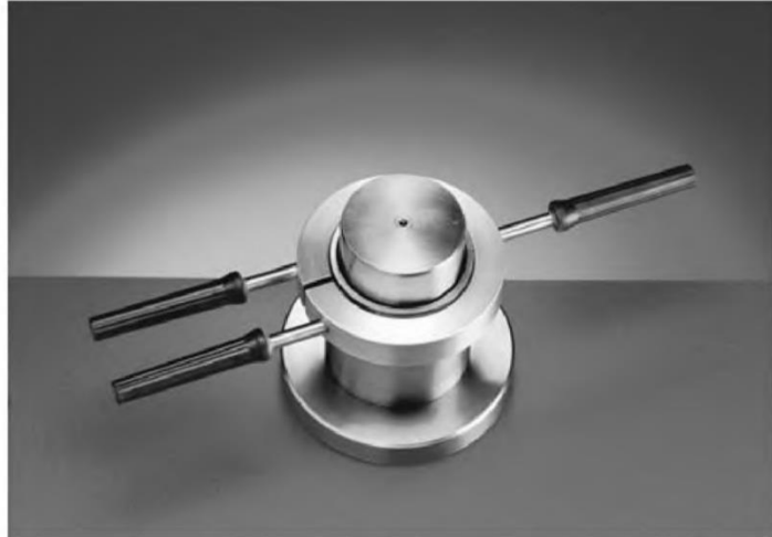
Gambar 7.22 Cincin pemanas aluminium untuk melepas inner race bantalan bola
