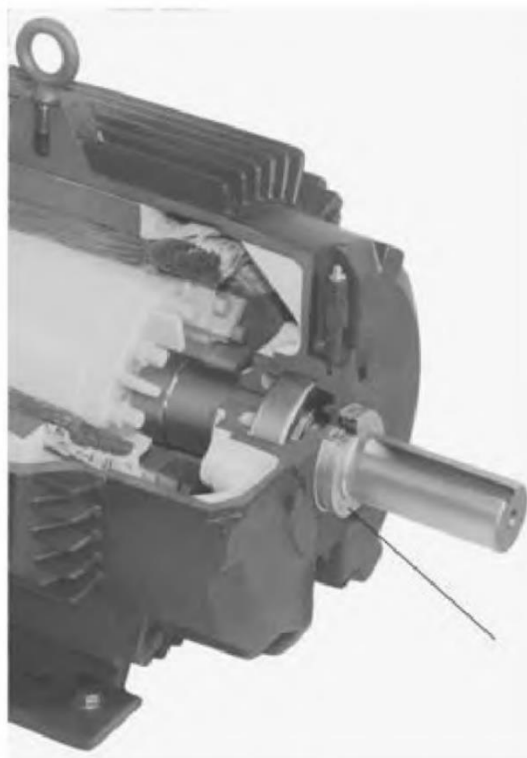
Gambar 7.20 Segel nonkontak yang mencegah sebagian besar kontaminan keluar sambil menjaga agar gemuk tetap masuk. Inpro/Seal Co.
