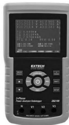
Gambar 8.15 Alat untuk memeriksa faktor daya dan kualitas daya rangkaian.
