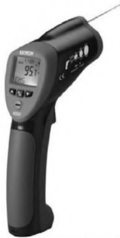
Gambar 8.7 Pistol inframerah adalah instrumen nonkontak untuk mendeteksi masalah yang berhubungan dengan suhu. Instrumen ECU EXT.
