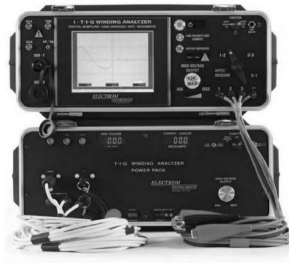
Gambar 7.2 Winding analyzer digunakan untuk melakukan uji tegangan langkah. Instrumen Elektrom.
