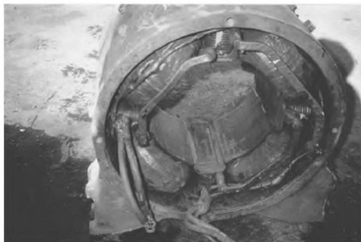
Gambar 1.20 Sebuah stator luka shunt empat kutub. Layanan MinePro P6-H.
