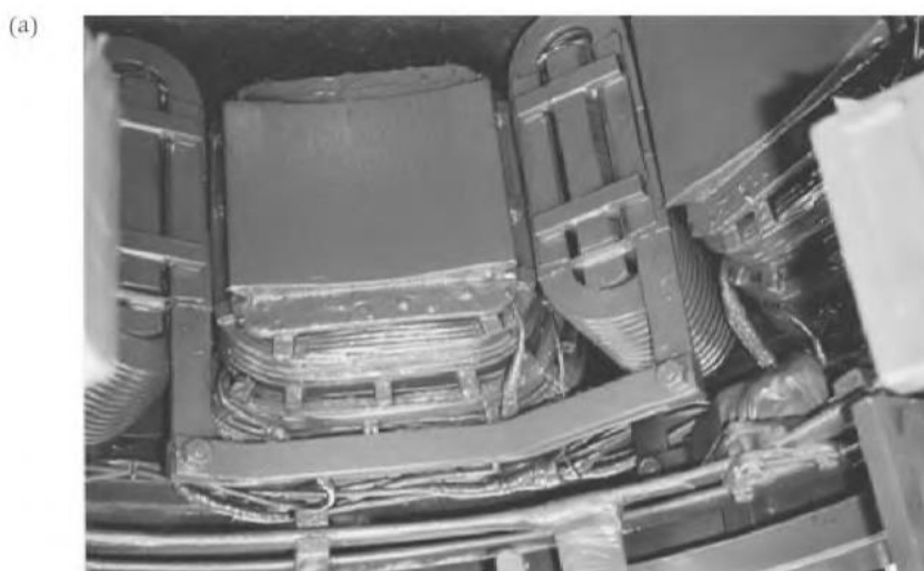
Gambar 2.19 (a) Sisi sambungan dari stator medan shunt dua sirkuit.
