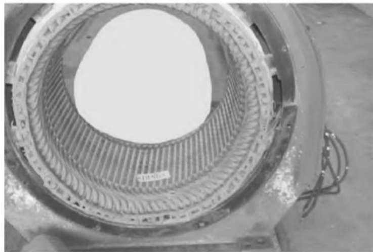
Gambar 5.5 Stator dari alternator tiga fasa memiliki belitan yang identik dengan motor tiga fasa. Layanan Smith.
