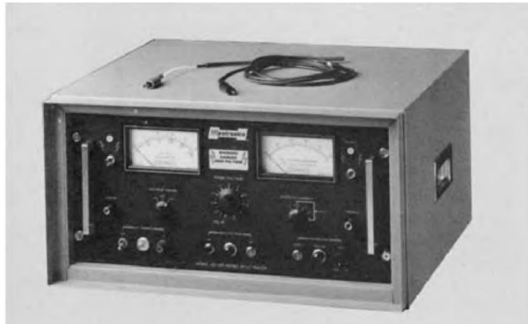
Gambar 8.14 Alat uji potensi tinggi (hi-pot). Hipotronics, Inc.
