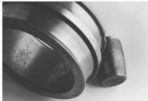
Gambar 7.24 Penandaan yang ditemukan pada kegagalan bantalan akibat arus listrik.
