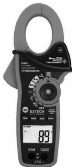
Gambar 8.2 Amperemeter penjepit (dengan fungsi ohmmeter) memberikan ampere
