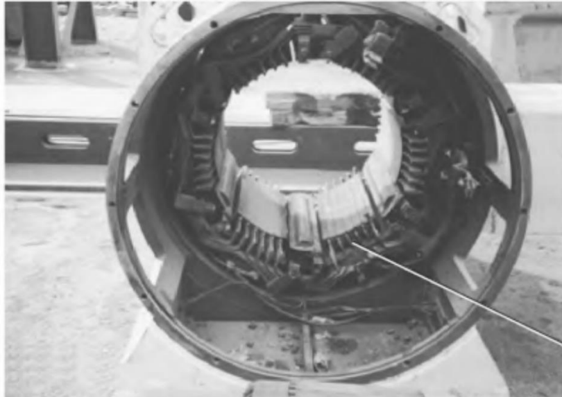
Gambar 2.11 Hubungan pendek dalam bidang seri ini juga melelehkan belitan kompensasi. Layanan Pro Tambang P&H
