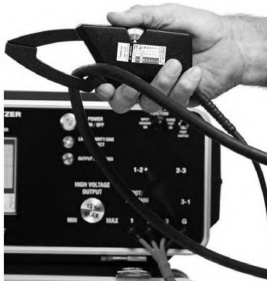
Gambar 8.11 Penjepit rotor digunakan untuk menguji masalah rotor saat motor berjalan. Instrumen Elektrom.
