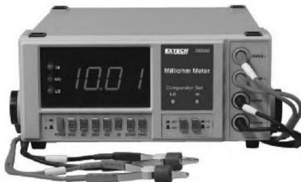
Gambar 8.4 Sebuah mikrohmeter dirancang untuk pengujian resistansi rendah. Instrumen EXTECH
