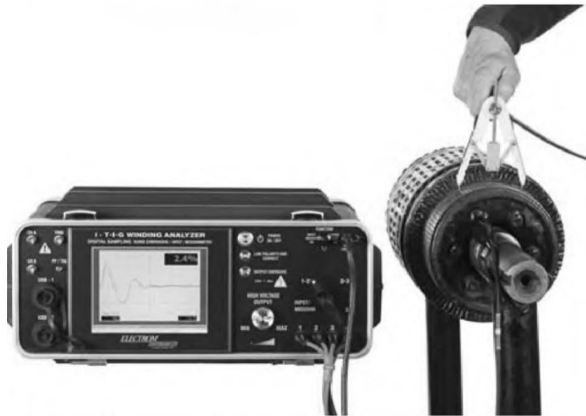
Gambar 8.12 Adaptor yang digunakan untuk menguji belitan jangkak dengan penguji surja.
