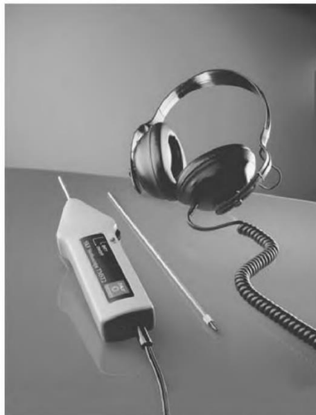
Gambar 8.8 Stetoskop yang digunakan untuk menunjukkan masalah.
