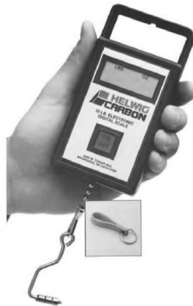
Gambar 2.4 Skala yang digunakan untuk pengukuran yang tepat dari tegangan pegas sikat.
