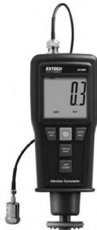
Gambar 8.16 Alat ini akan memeriksa getaran, dan memiliki kemampuan takometer nonkontak. Instrumen EXTECH
