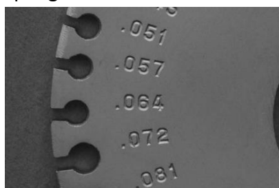
GAMBAR 6-15 Sisi berlawanan dari pengukur kawat mencantumkan diameter kawat dalam seperseribu inci.
