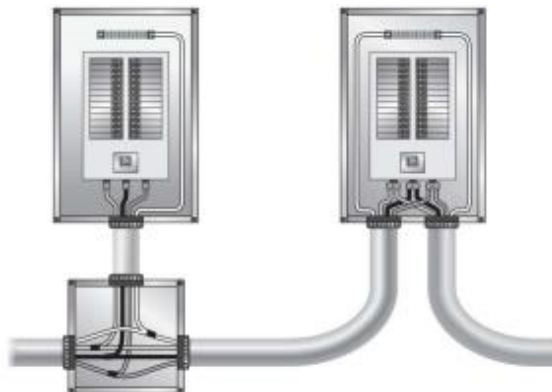
GAMBAR 4-2 Metode penyambungan kotak panel.
