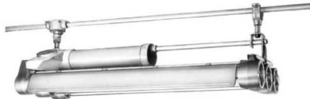
GAMBAR 19-16 Luminer fluorescent tahan ledakan: digunakan di Kelas I, Grup C, D; Kelas II Kelompok E, F, G; area semprotan cat; dan lokasi basah.
