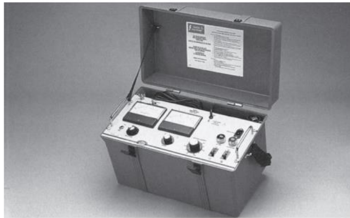
GAMBAR 2-43 Penguji tegangan tinggi.
