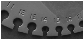
GAMBAR 6-14 Satu sisi pengukur kawat mencantumkan ukuran AWG kawat.
