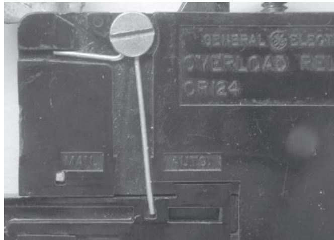
GAMBAR 8-25 Relai beban berlebih strip bimetal umumnya dapat diatur untuk memungkinkan reset otomatis atau manual dari kontak bantu.
