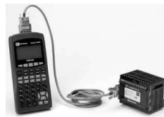
GAMBAR 16-3 Terminal pemrograman genggam dan PLC kecil.
