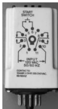
GAMBAR 8-58 Diagram pin untuk pengatur waktu multifungsi.
