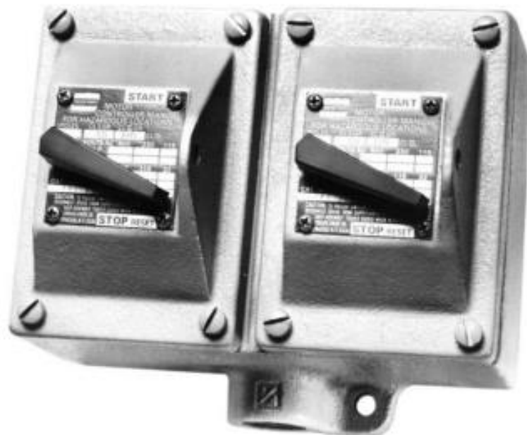
GAMBAR 19-19 Starter motor manual ganda yang digunakan di lokasi berbahaya: digunakan di Kelas I, Grup C, D; Kelas II, Golongan E, F, G; dan Kelas III.
