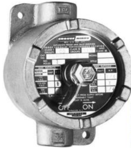
GAMBAR 19-20 Starter motor manual tunggal yang digunakan di lokasi berbahaya: digunakan di Kelas I, Grup B, C, D; Kelas II, Golongan E, F, H; dan Kelas III.
