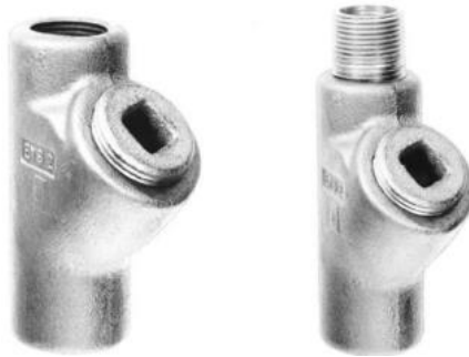
GAMBAR 19-5 Segel yang dirancang untuk dipasang pada posisi vertikal: digunakan di Kelas I, Grup A, B, C, D; dan Kelas II, Grup E, F, G.
