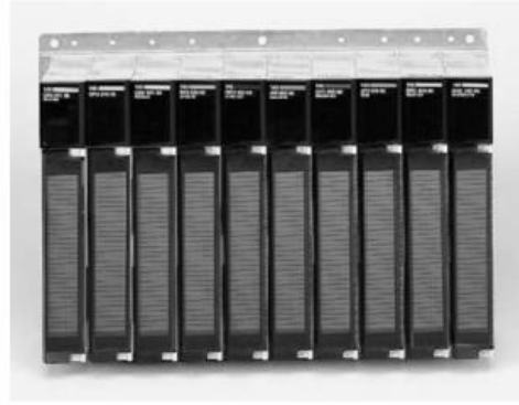
GAMBAR 16-8A Rak I/O dengan modul input dan output.
