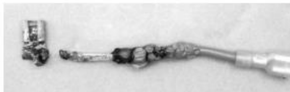
GAMBAR 4-5 Konduktor dan terminal terbakar karena koneksi yang buruk.
