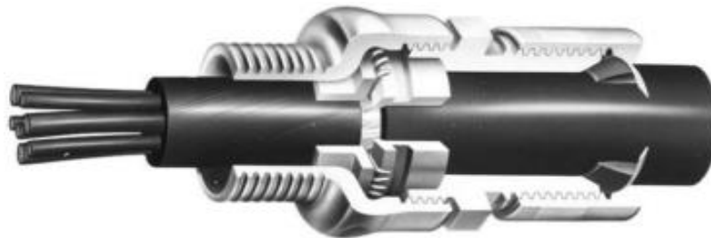
GAMBAR 19-1 Kabel tipe SNM dengan fitting terminasi yang disetujui: digunakan di Kelas I, Grup A, B, C, D, Divisi 2; Kelas II, Grup G, Divisi 2; dan Kelas III.
