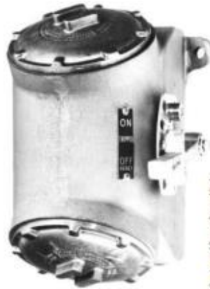
GAMBAR 19-10 Pemutus sirkuit tunggal dalam selungkup tahan ledakan: digunakan di Kelas I, Grup C, D; Kelas II, Golongan E, F, G; dan Kelas III.
