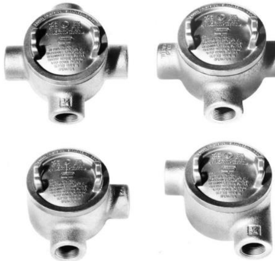
GAMBAR 19-3 Kotak outlet tahan ledakan: digunakan di Kelas I, Grup C, D; Kelas II, Golongan E, F, G; dan Kelas III.
