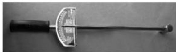
GAMBAR 4-6 Kunci pas torsi digunakan untuk mengencangkan mur dan baut hingga kekencangan tertentu.
