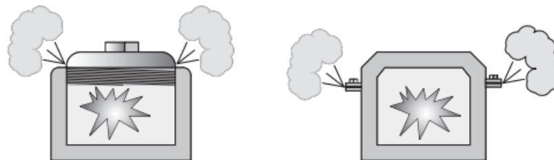
GAMBAR 19-2 Gas panas didinginkan sebelum meninggalkan enklosur.
