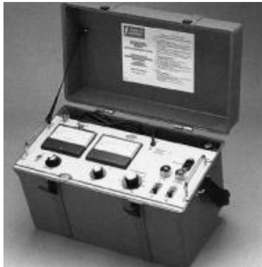
GAMBAR 11-28 Satu set uji dielektrik.
