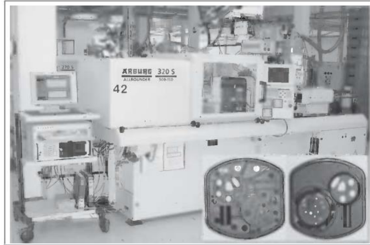
Gambar 299: Produksi Casing Cetakan Injeksi Untuk Jam Digital (Sumber: PKT )
