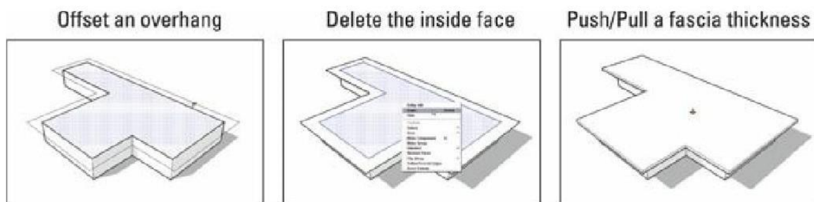
Gambar 4-33: Atap adalah bagian atap yang menggantung pada dinding bangunan.
