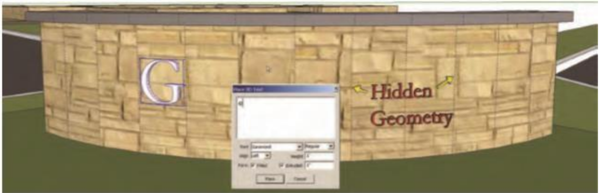
Gambar: Untuk membuat tanda, tambahkan teks 3D pada permukaan dinding.
