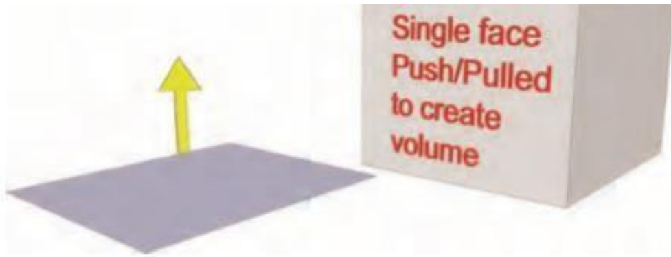
Gambar 1.17 Push/pull tool membuat volume 3D dari face.
