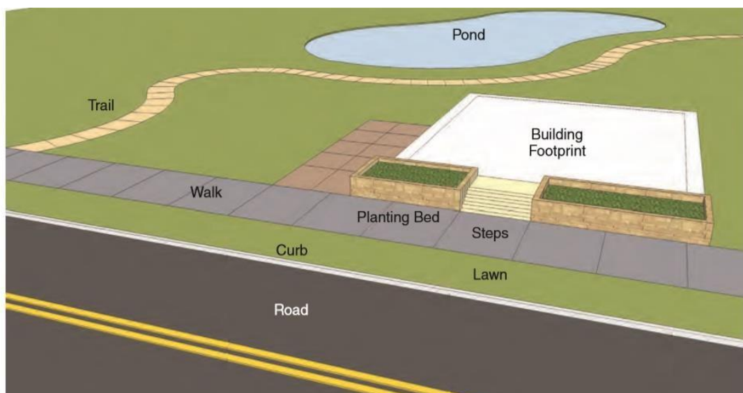
Gambar 8.1 Beberapa permukaan khas yang membentuk Flatwork Base
