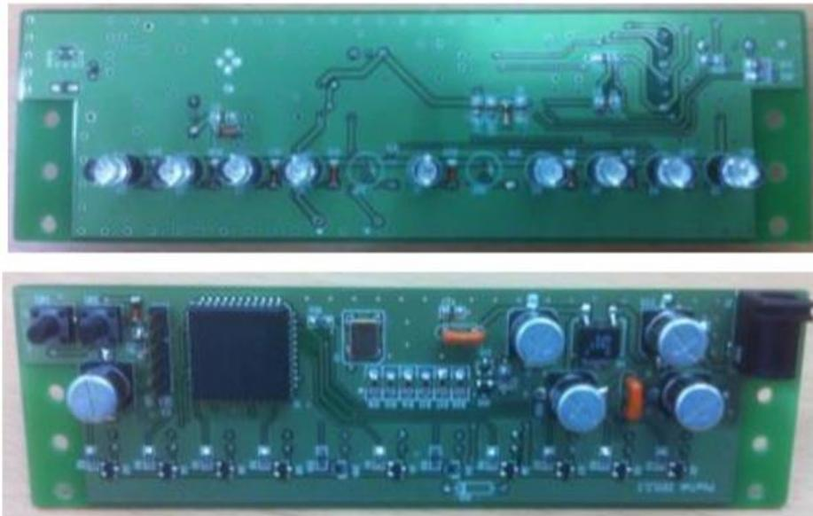
**Gambar 5.6** LED IR yang digunakan dalam proyektor Prakash
