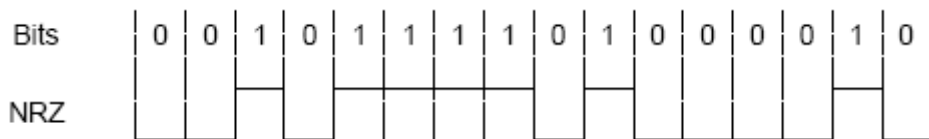
Gambar 11-2 Contoh pengkodean dengan skema NRZ
