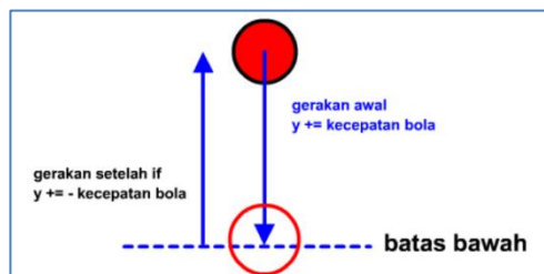
Gambar 3.12 gerakan pantulan secara vertical
