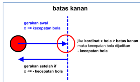
Gambar 3.11 gerakan pantulan benda secara horizontal
