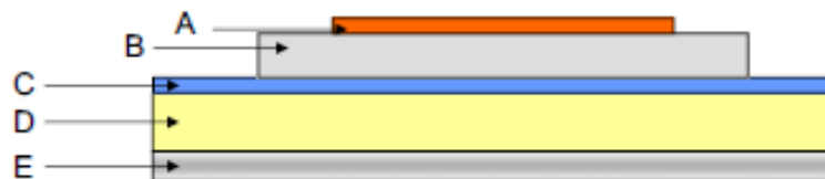
Gambar 15.10 Struktur piksel AMOLED.a, lapisan anti pantulan; B dengan katoda; C, lapisan organik; D dengan aksesoris anoda; E, substrat kaca.
