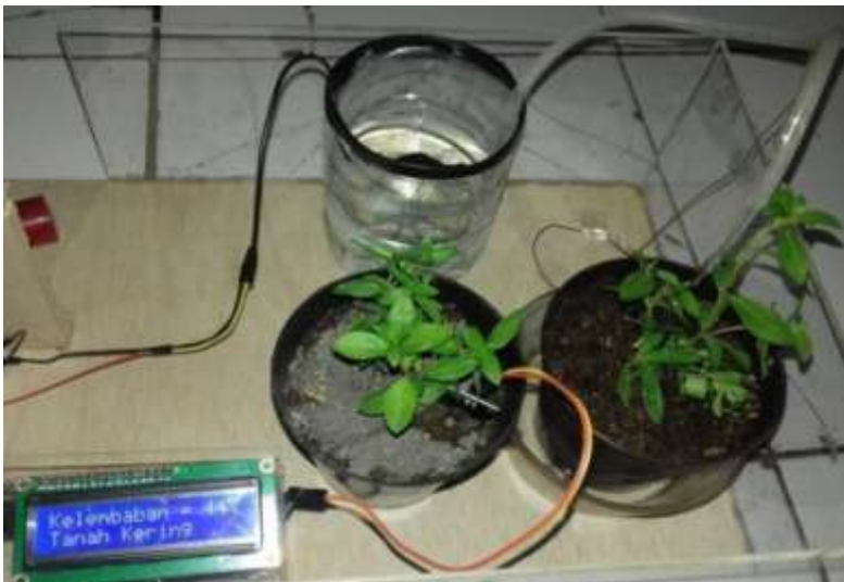
Gambar 42. Ketika kondisi tanah kering dan pompa menyiram
