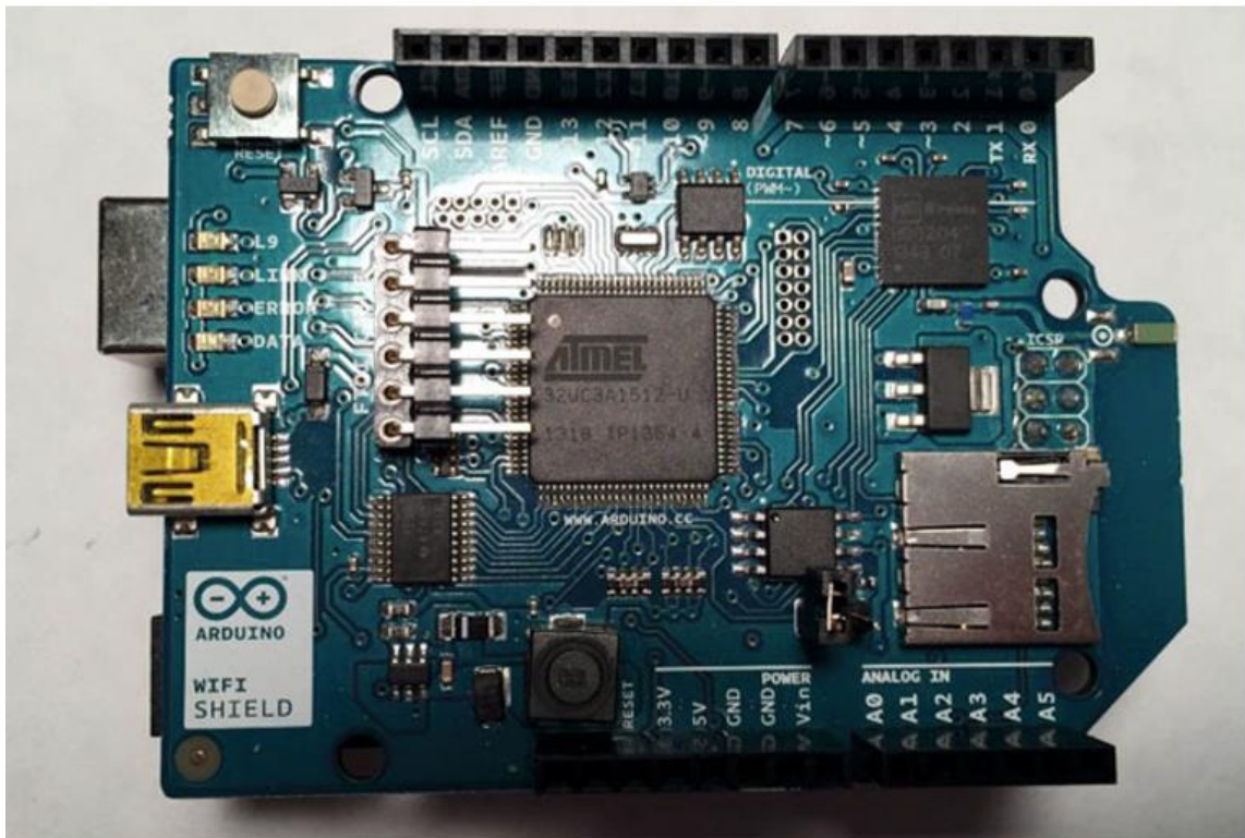
Gambar 2-5. Shield WiFi terpasang di bagian atas Arduino Uno
