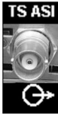
Gambar 10.9. Konektor TS-ASI (75 Ohm, BNC)
