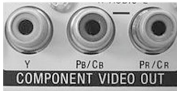
Gambar 10.1. Soket RCA, untuk sinyal video komponen dalam contoh ini
