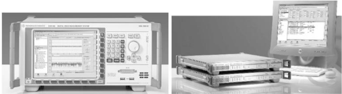
Gambar 11.11. Penganalisis MPEG-2, Rohde&Schwarz, di sebelah kiri: DVM400, di sebelah kanan: DVM100
