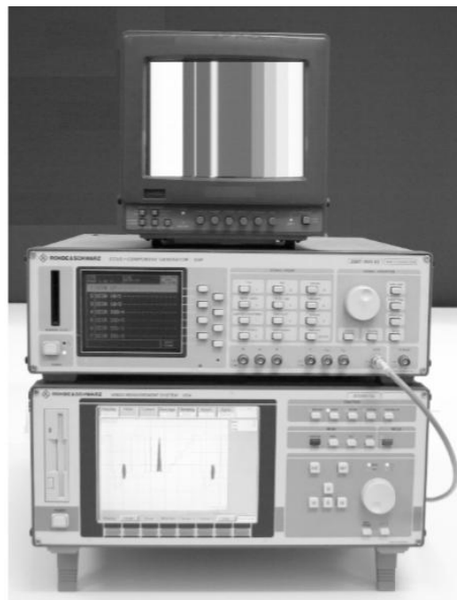
Gambar 2.22 Peralatan uji dan pengukuran video analog: generator sinyal uji video dan penganalisis video (Rohde&Schwarz SAF dan VSA)
