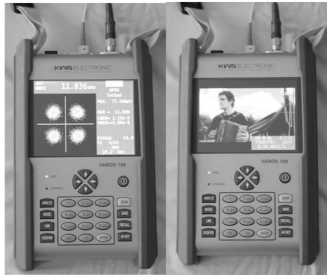
Gambar 15.9. Pengukuran pada sistem antenna satelit menggunakan antenna penerima uji (KWS VAROS 109).
