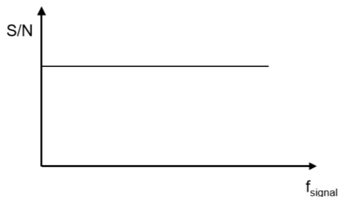
Gambar 13.33. Rasio sinyal/noise LF di AM sebagai fungsi dari frekuensi sinyal pita dasar
