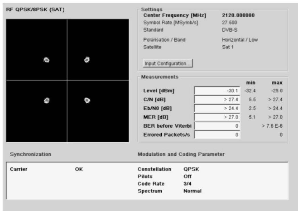
Gambar 15.4. Diagram konstelasi sinyal DVB-S yang tidak terganggu dengan pengukuran MER dan BER
