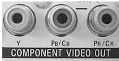
Gambar 7.1. Soket RCA, untuk sinyal video komponen dalam contoh ini
