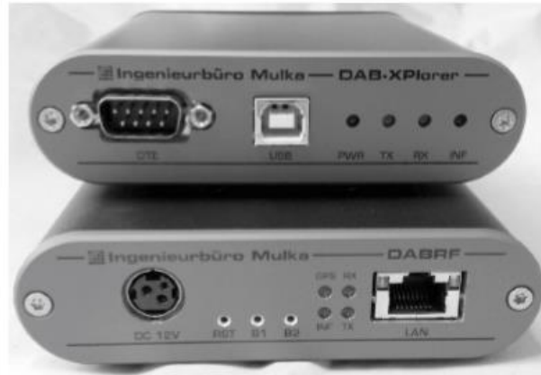
Gambar 9.45. DAB-XPlorer untuk analisis ETI/EDI
