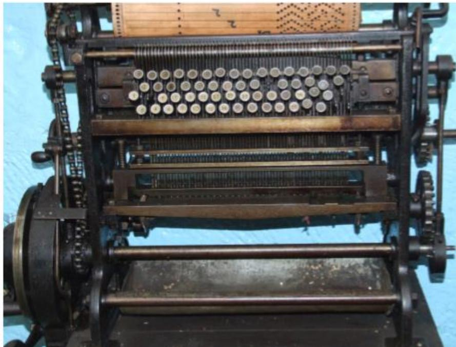
**Gambar 1-2.** Pemotong Kartu Jacquard Masson Mills WTM 10, 1783, yang digunakan untuk membuat kartu berlubang yang dibaca oleh alat tenun Jacquard
