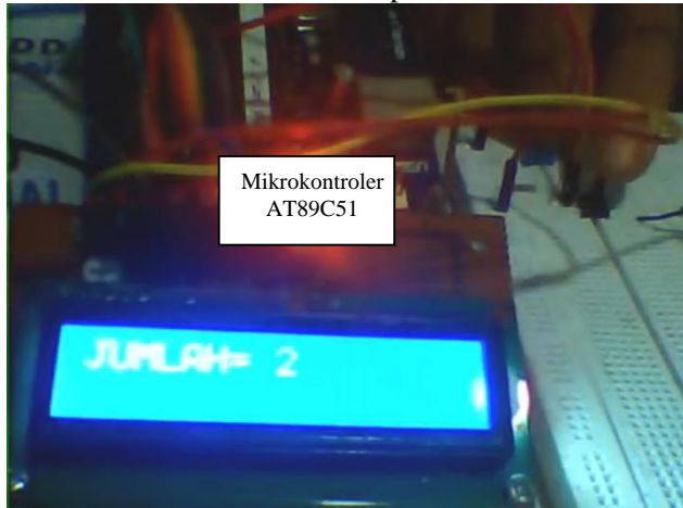
Gambar 2.26. Eksperimen Button OFF maka LCD = 2
