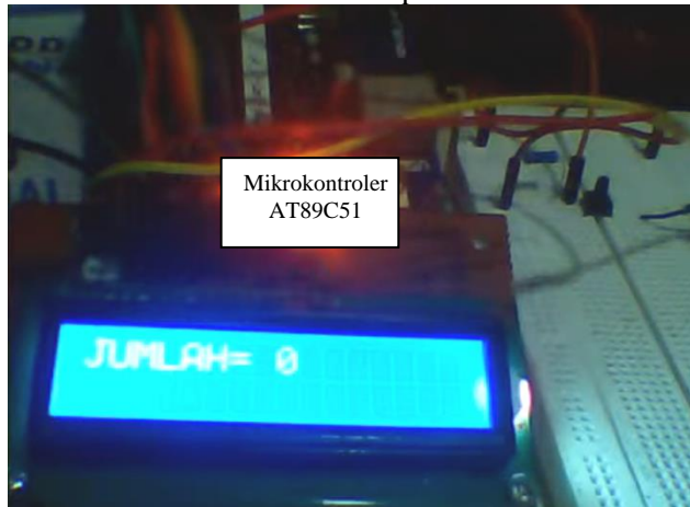
Gambar 2.25. Eksperimen Button OFF maka LCD = 0
