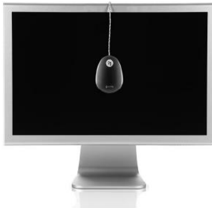
Gambar 44 Menampilkan profil. Instrumen profil, dalam hal ini kolorimeter, mengukur nilai dari permukaan layar.
