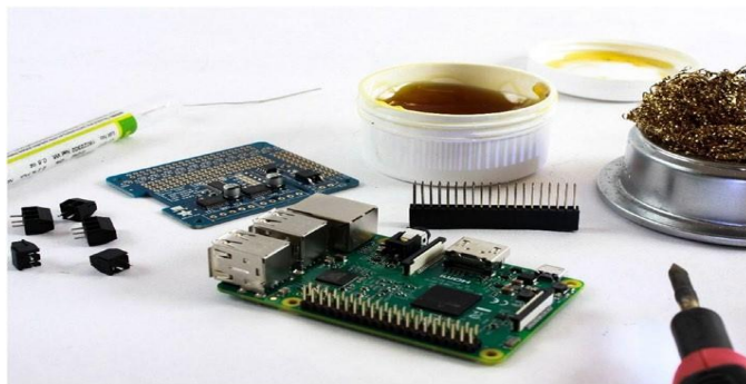
Gambar 6-5. Persiapan merakit motor HAT
