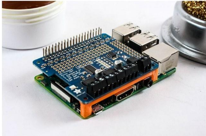
Gambar 6-14. Papan yang telah selesai dipasang pada Raspberry Pi. Bagian dukungan oranye dicetak 3D.
