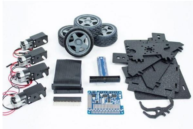
Gambar 1-5. Bagian sasis Runt Rover dan Pi T Cobbler, kabel pita, topi kontrol motor, dan tajuk yang diperpanjang
