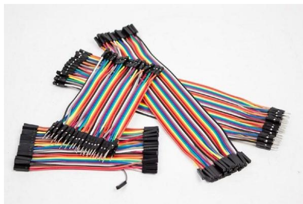
Gambar 1-7. Jumper dalam bentuk kabel pita. Tarik apa yang Anda butuhkan
