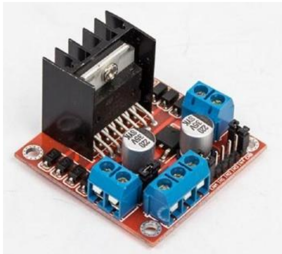
Gambar 1-9. Modul pengontrol motor ganda L298N hadir dalam berbagai jenis, tetapi pada dasarnya berfungsi sama
