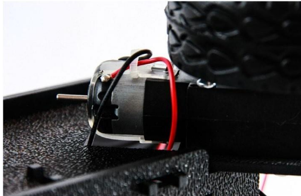
Gambar 7-8. Kabel motor dimasukkan melalui lubang di belakang motor
