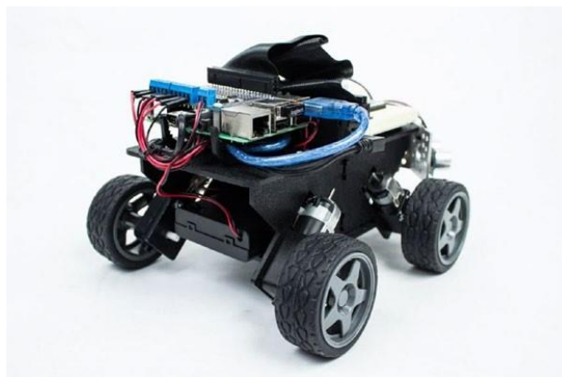
Gambar 1-4. Bagian belakang robot kami menunjukkan Raspberry Pi dan papan kontrol motor
