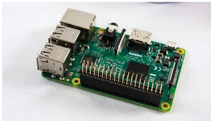
Gambar 6-6. Header susun yang diperluas pada GPIO 40-pin Pi
