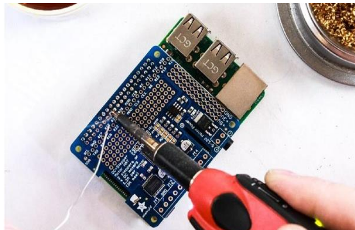
Gambar 6-10. Putar Pi dan solder pin yang tersisa
