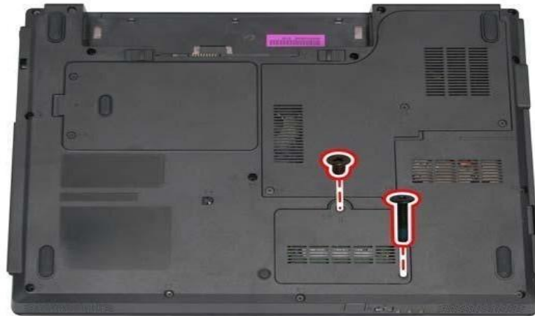
Gambar 4.9 Sekrup penutup RAM
