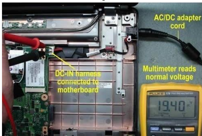
Gambar 11.1 Pengujian adaptor AC/DC menggunakan alat multimeter
