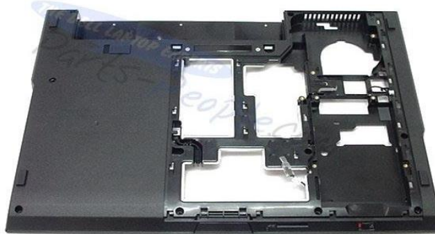
Gambar 2.19 Rangka bawah Laptop
