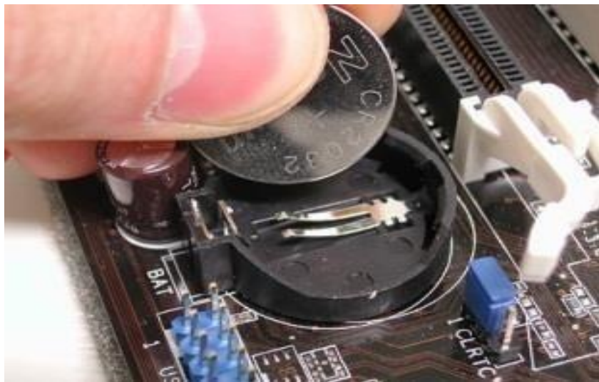
Gambar 8.7 Mengecek Baterai CMOS apakah terkena air atau tidak
