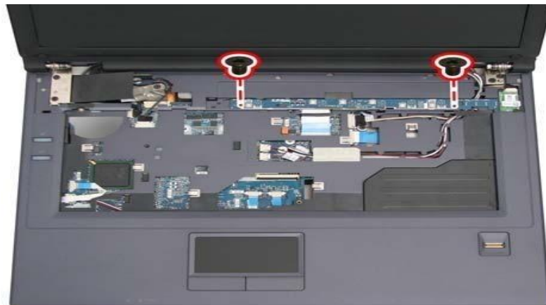
Gambar 4.15 Melepaskan Sekrup Papan Sakelar
