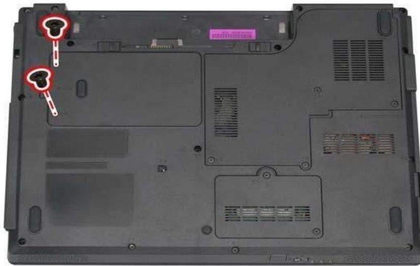
Gambar 4.4 Lokasi Sekrup Penahan HDD
