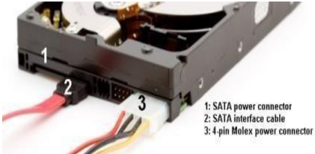
Gambar 6.4 Konektor dan Catu daya
