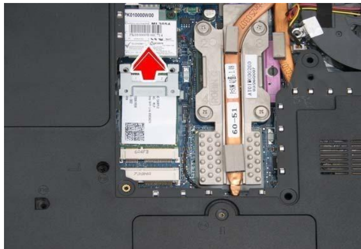
Gambar 4.20 Braket Penyangga WLAN
