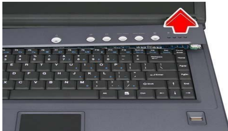
Gambar 4.13 Membuka Penutup Strip Keyboard
