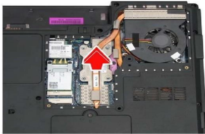
Gambar 4.24 Melepaskan Modul dari Motherboard
