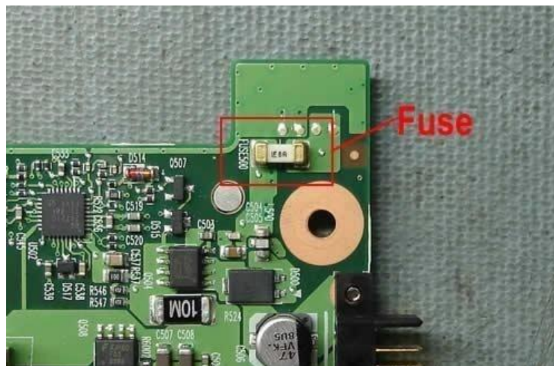
Gambar 11.2 Fuse/sekering di motherboard laptop sebagai pengaman tegangan arus listrik
