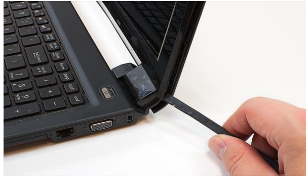
Gambar 7.3 melepas Engsel pada Laptop
