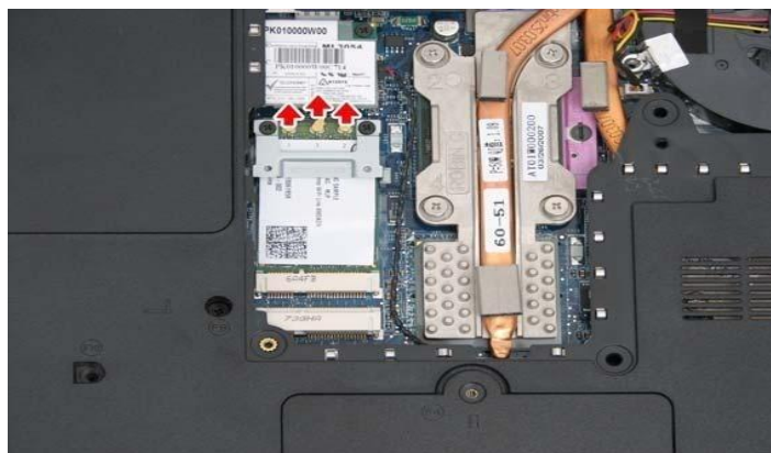
Gambar 4.18 Antena WLAN yang terpasang
