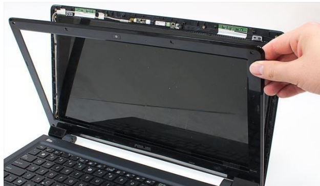
Gambar 7.4 Melepas Braket LCD
