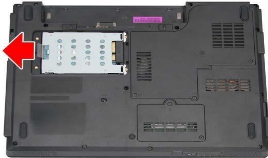
Gambar 4.7 Melepaskan Modul HDD
