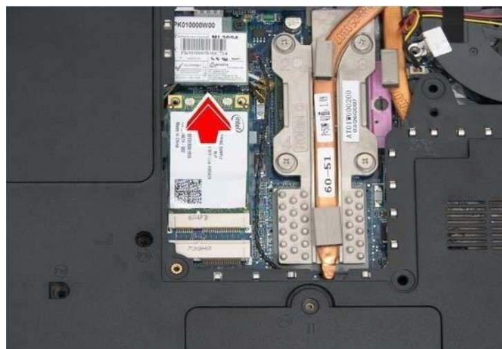
Gambar 4.21 Menarik LAN Nirkabel dari Soket
