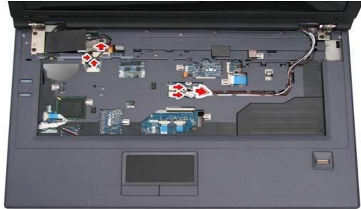
Gambar 4.28 Melepas kabel Daya pada LCD
