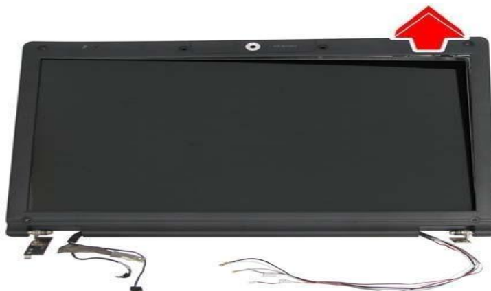
Gambar 4.33 Melepas Bezel LCD
