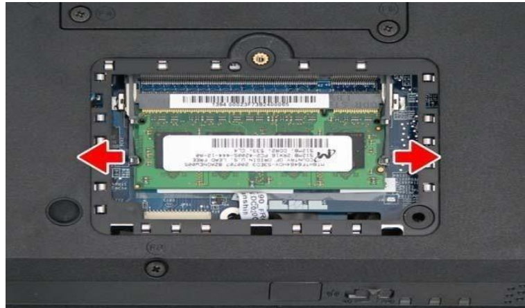
Gambar 4.10 Kait Pendorong untuk Melepas RAM
