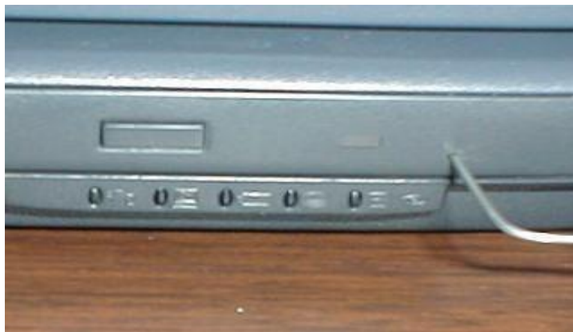
Gambar 5.4 Menusuk lubang Harddisk Menggunakan Papperclip
