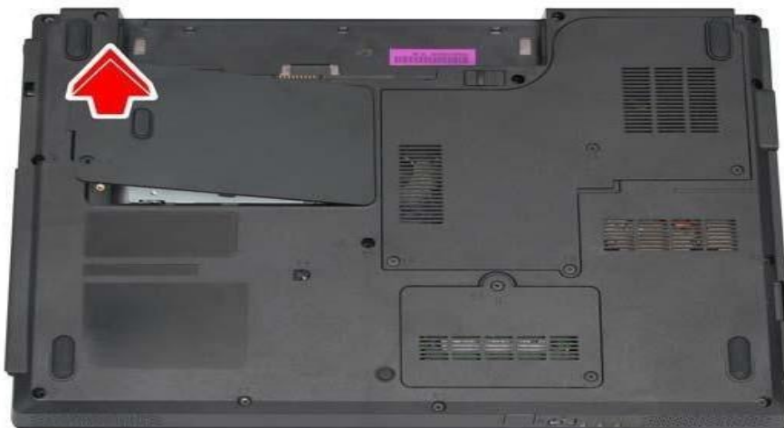
Gambar 4.5 Membuka Tutup HDD
