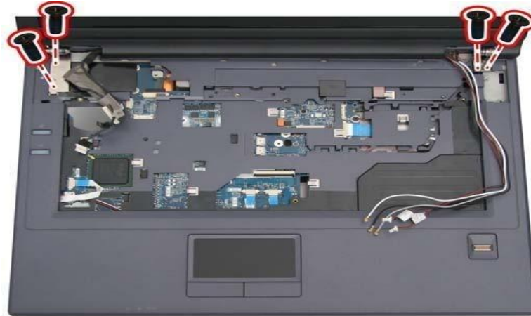
Gambar 4.29 Melepas Sekrup Modul LCD
