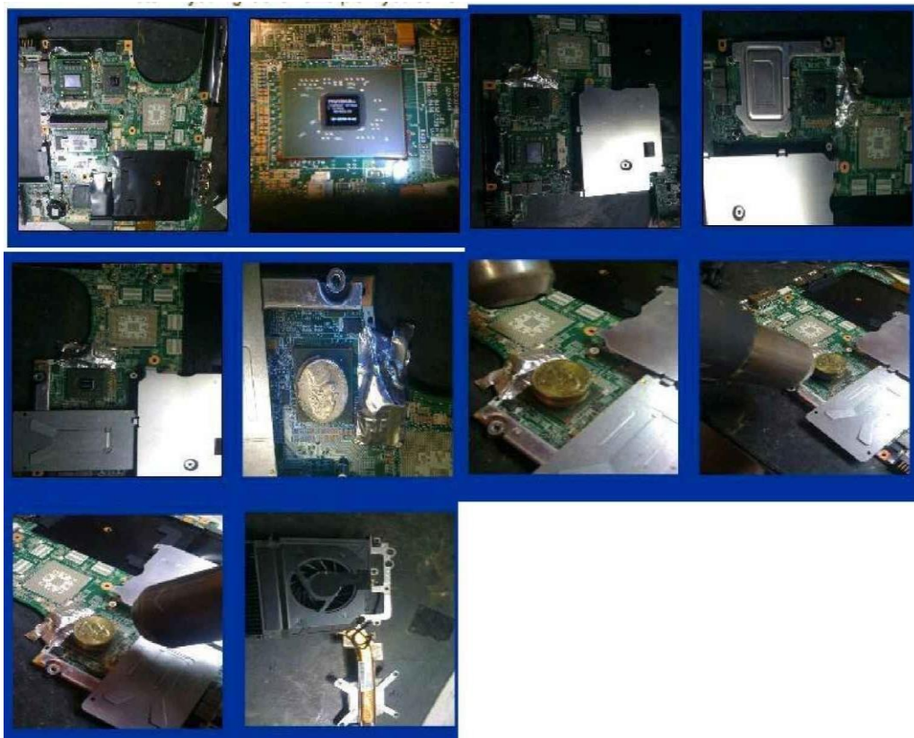
Gambar 8.22 Pemantauan suhu selama reflow
