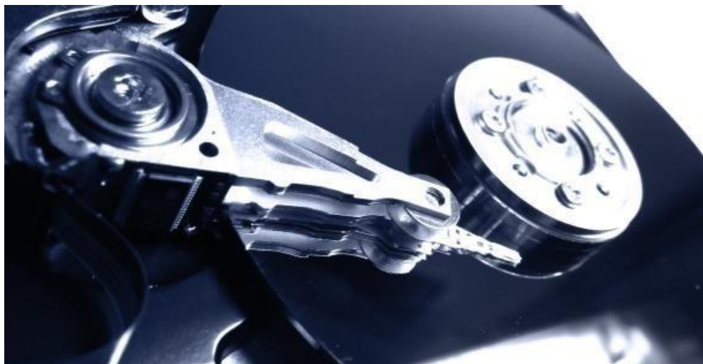
Gambar 6.5 Pembaca Data pada Harddisk
