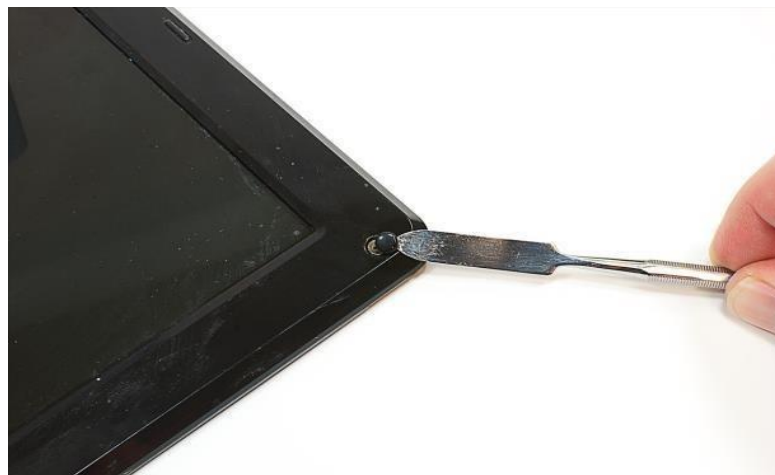
Gambar 7.2 Melepas katup Layar LCD
