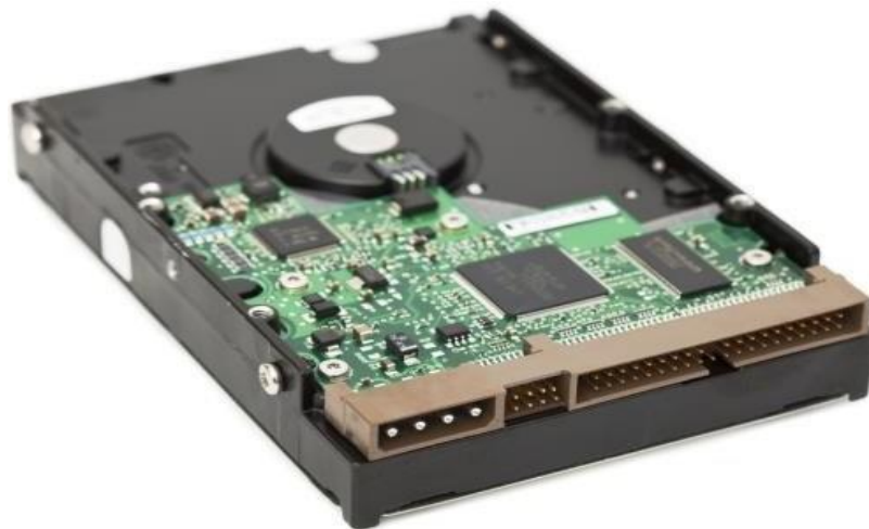
Gambar 6.8 Penampang Konektor Harddisk
