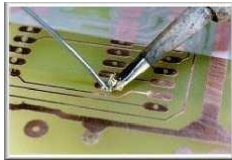
Gambar 10.3 Visual proses solder komponen
