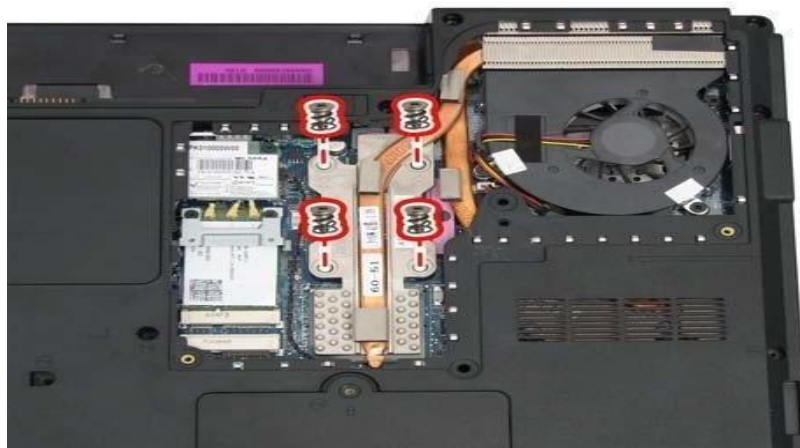
Gambar 4.23 Sekrup Pegas Penahan Modul
