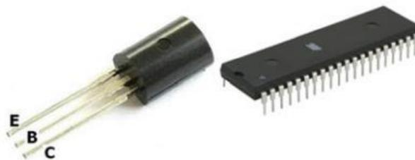
**Gambar 2.16** Transistor (kiri), IC (kanan)
