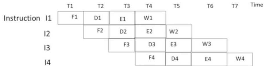
**Gambar 6.10** Eksekusi instruksi menggunakan pipeline
