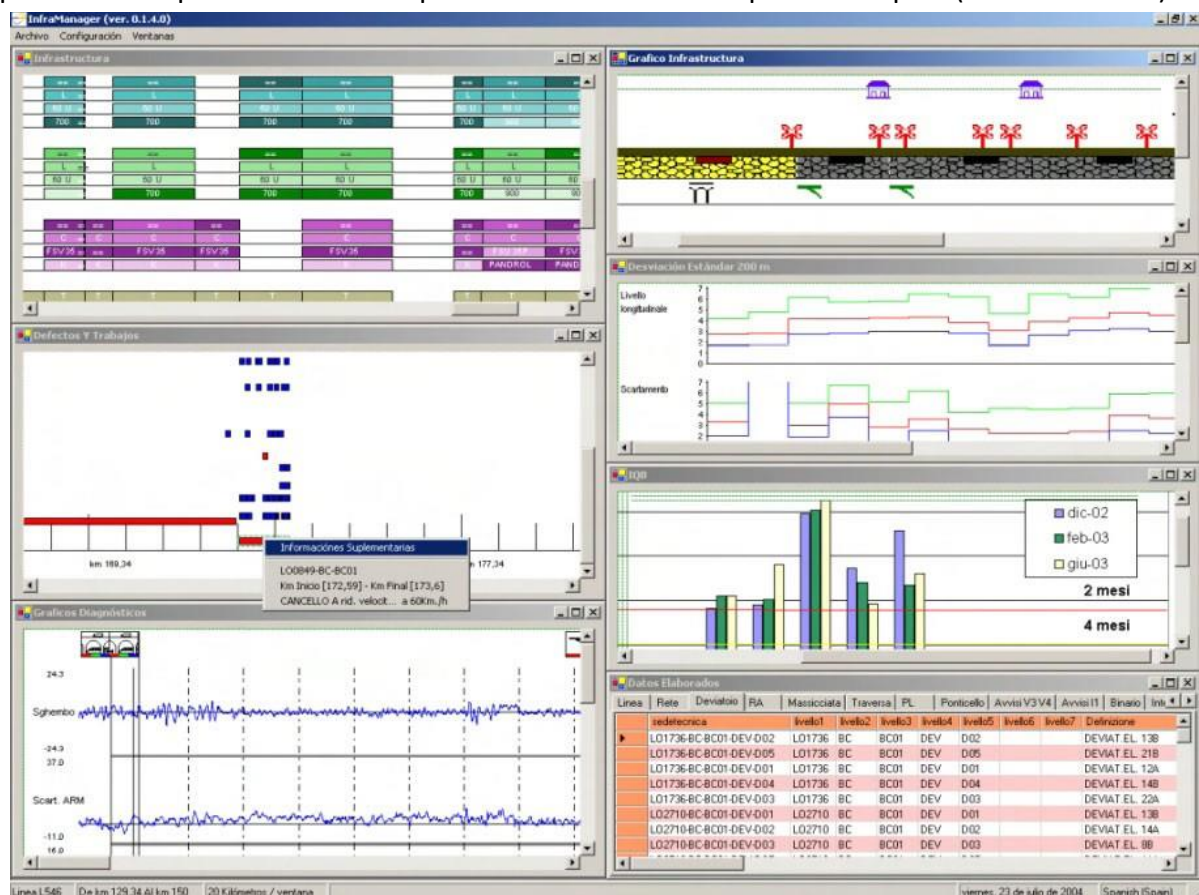
Gambar 11.8 Diagnostik grafis dan analisis kondisi teknis infrastruktur transportasi kereta api di Ramsys DSS
