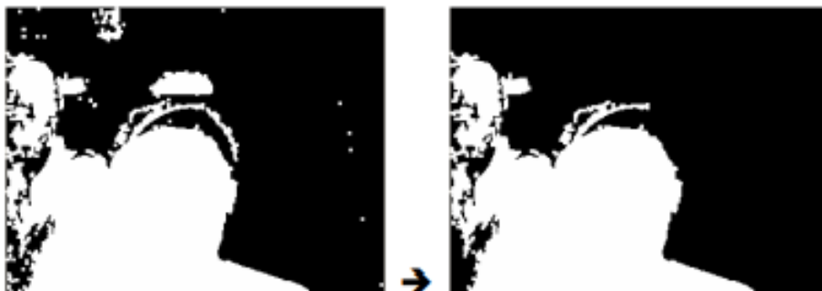
Gambar 17.2 Hasil Penerapan Algoritma Segmentasi pada Citra Noisy
