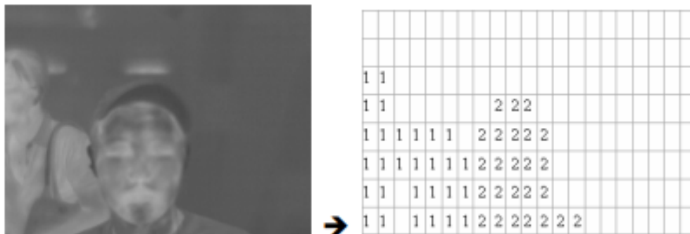
Gambar 17.3 Hasil Segmentasi Penerapan Algoritma Fuzzy C-Means
