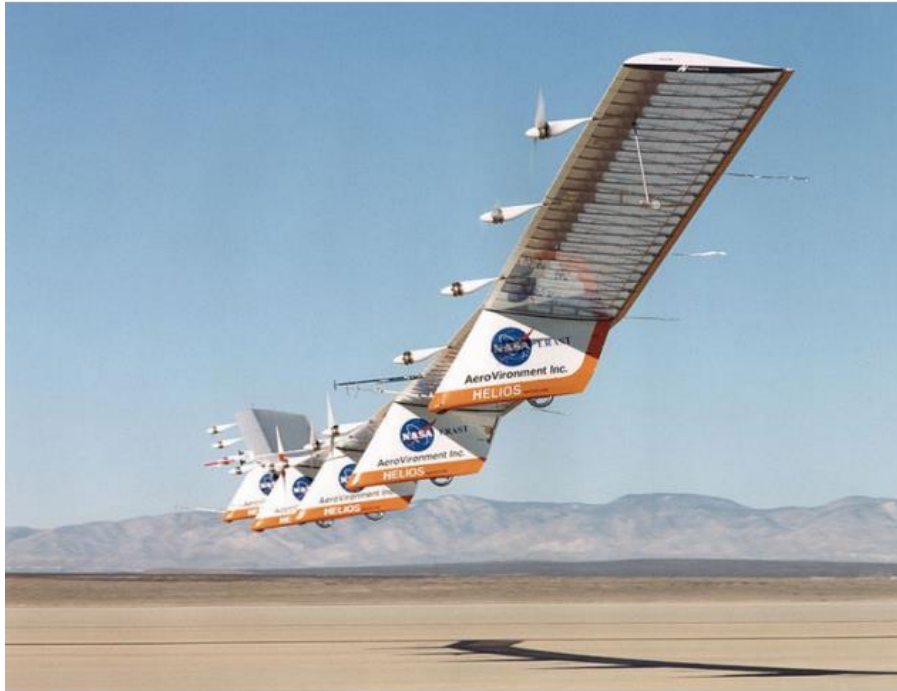
Gambar 6.23 Prototipe pesawat surya Helios NASA. Sumber: Wikimedia
