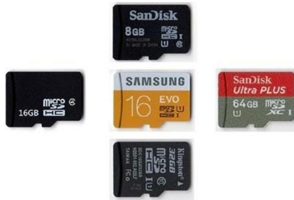
**Gambar 3-2** Kartu microSD 8GB, 16GB, dan 32GB dapat digunakan oleh Raspberry Pi tanpa memformat ulang. Namun, kartu 64GB harus diformat ulang sebagai FAT32 sebelum dapat dikenali.
