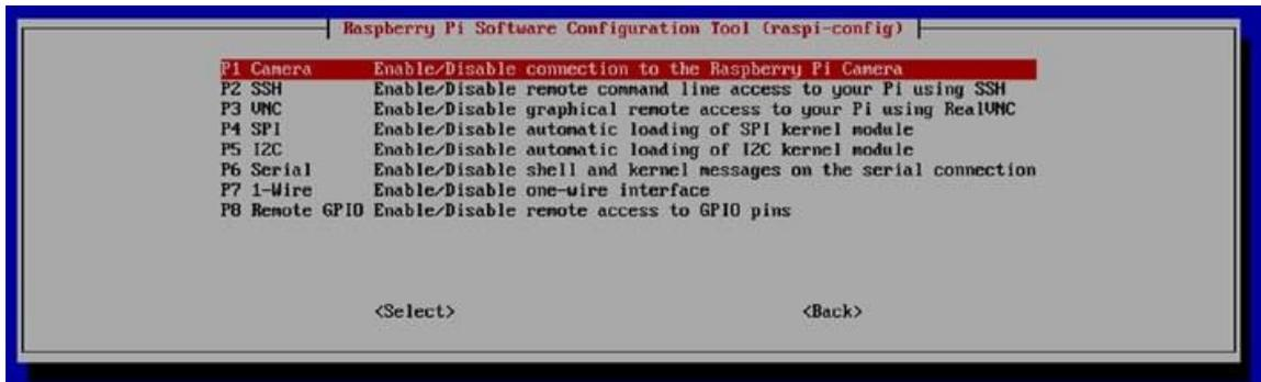
**Gambar 7-5** Mengaktifkan kamera Raspberry Pi menggunakan raspi-config
