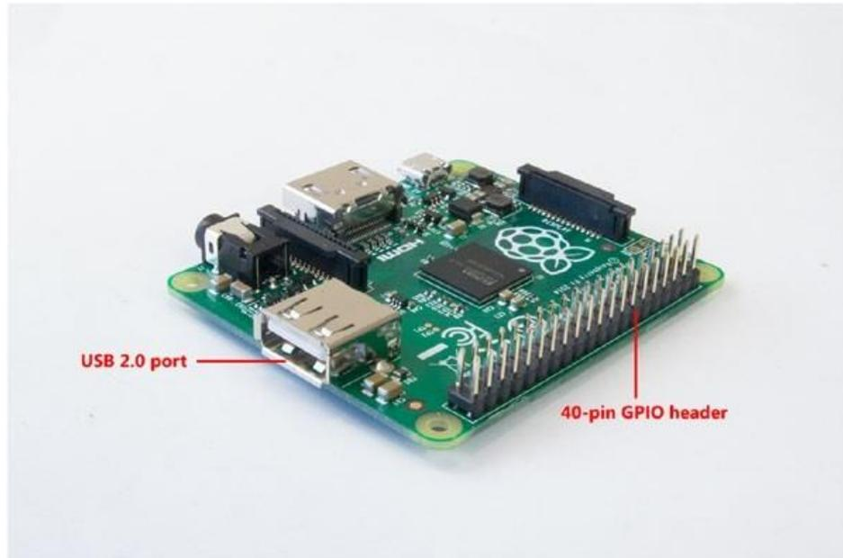
**Gambar 1-3** Port USB Raspberry Pi Model A+ dan konektor GPIO 40-pin
