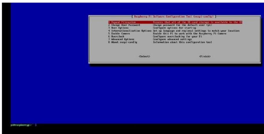
**Gambar 2-3** Beberapa opsi konfigurasi tersedia melalui utilitas raspi-config, tetapi sebagian besar perubahan pada sistem Anda harus diterapkan melalui baris perintah
