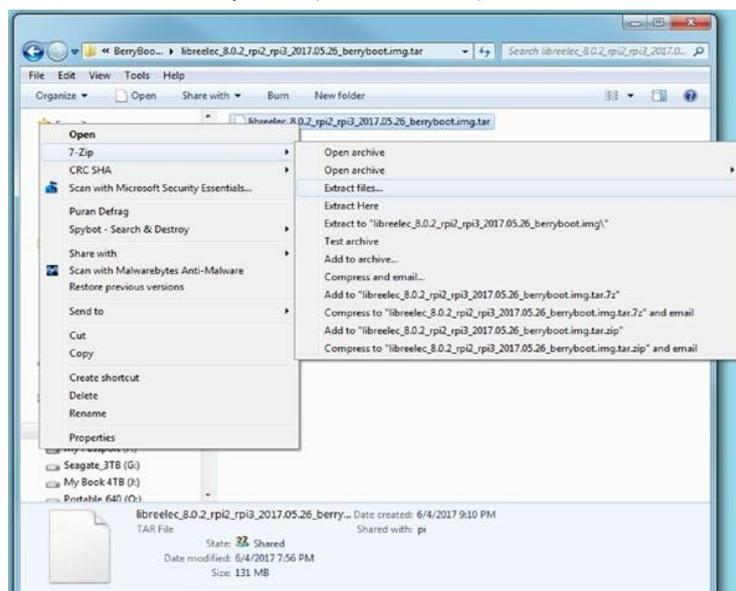
**Gambar 8-2** Melakukan ekstraksi kedua dari dua dengan 7-Zip (TAR ke IMG)
