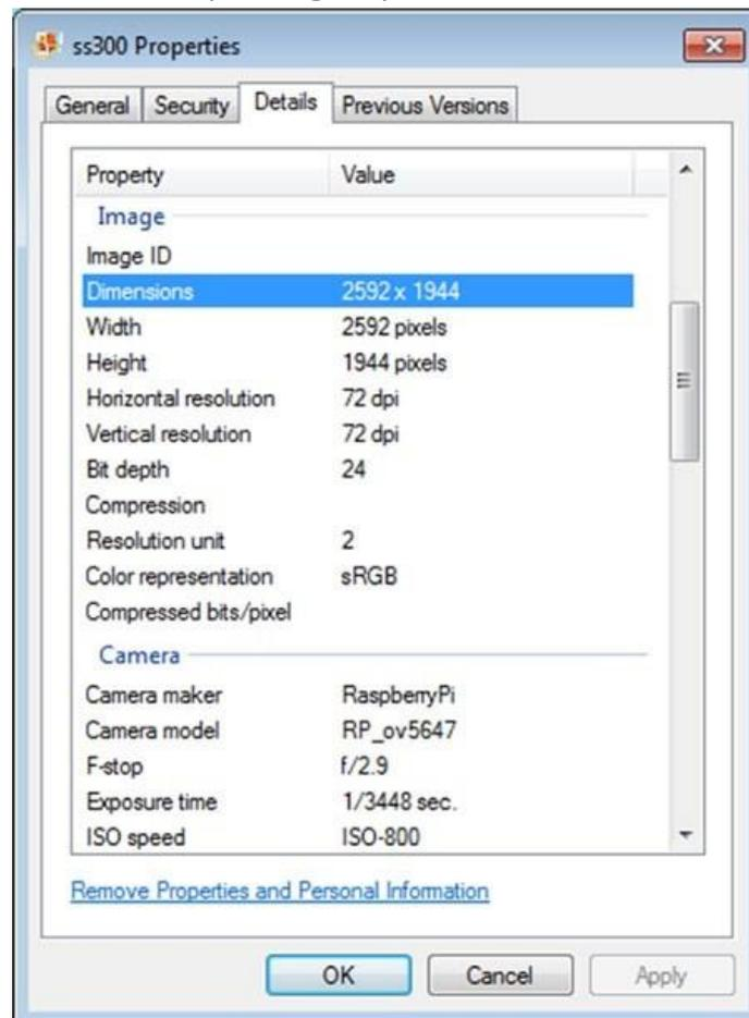
**Gambar 7-10** Melihat eksposur dan metadata kamera dengan Windows Explorer
