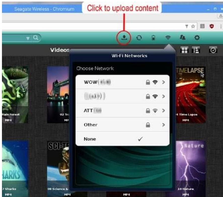
**Gambar 4-9** Bersiap untuk menyambung ke jaringan nirkabel default melalui dialog jaringan Seagate Wireless Plus
