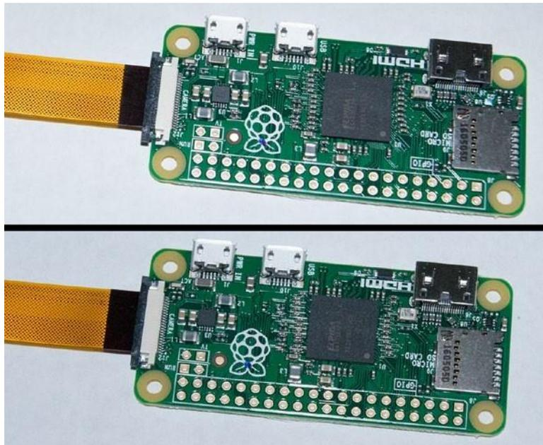
**Gambar 7-4** Menggeser kabel kamera Pi Zero ke dalam konektor kamera Pi Zero/Zero W (atas) dan menjepit penutup klem (bawah)
