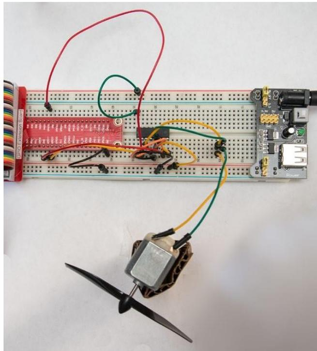
**Gambar 9-12** Mengontrol motor memerlukan catu daya eksternal, chip pengontrol, dan banyak
