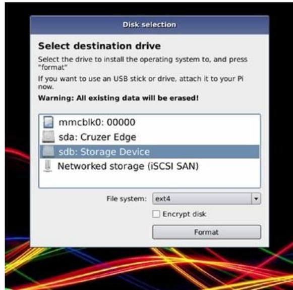
**Gambar 2-17** Bersiap untuk menginstal BerryBoot ke drive
