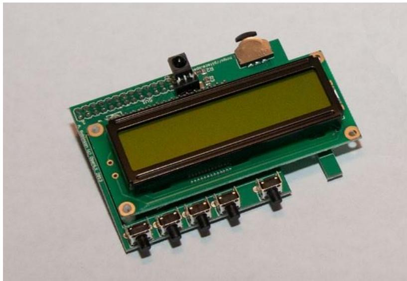
**Gambar 9-6** Papan Kontrol dan Tampilan PiFace sebelum dipasang pada Raspberry Pi
