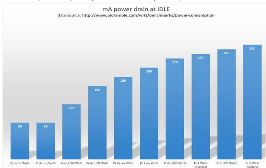
**Gambar 10-1** Mengaktifkan Wi-Fi (Pi 3) atau menggunakan adaptor Wi-Fi USB (model lain) meningkatkan konsumsi daya, tetapi Wi-Fi internal di Pi 3 (juga digunakan di Pi Zero, tidak ditampilkan) hanya menggunakan sekitar setengah daya saat idle dari adaptor Wi-Fi USB
