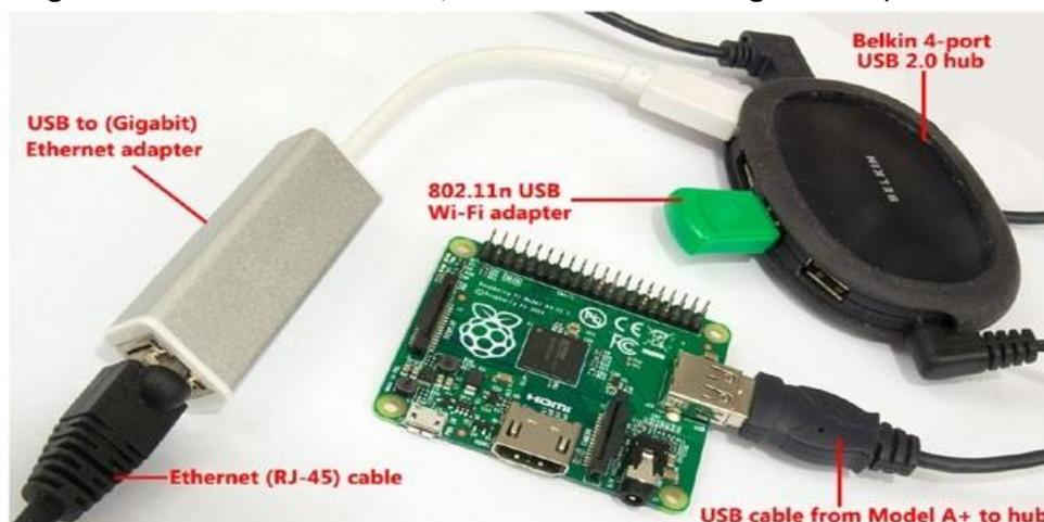
**Gambar 1-13** Raspberry Pi A+ menggunakan hub USB 4-port Belkin untuk terhubung ke adaptor Wi-Fi USB dan adaptor Ethernet USB
