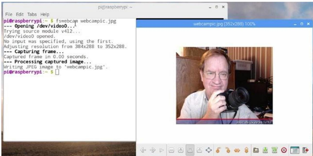
**Gambar 7-18** Fswebcam digunakan dengan pengaturan default (kiri) menangkap gambar kecil dari webcam (kanan)
