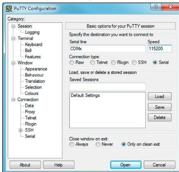
**Gambar 10-3** Menghubungkan ke Raspberry Pi dengan Putty. Ganti COMX dengan nomor port COM yang sebenarnya seperti yang dilaporkan oleh Windows Device Manager.
