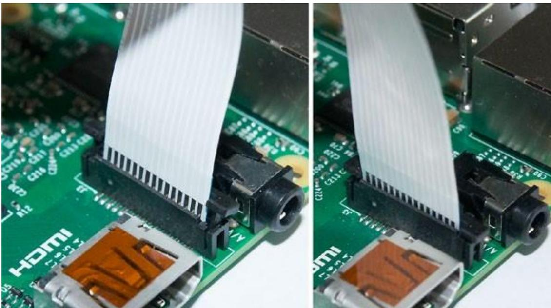
**Gambar 7-2** Memasukkan kabel kamera ke port kamera Raspberry Pi (kiri) dan mengamankan penjepit kabel (kanan)
