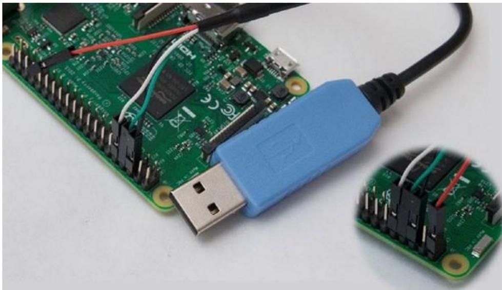
**Gambar 10-2** Kabel USB-to-TTL (debug) memungkinkan Anda terhubung ke pin GPIO Raspberry Pi Anda untuk kendali jarak jauh melalui TTY. Inset (kanan bawah) menunjukkan penggunaan kabel daya merah sebagai pengganti konektor daya Micro-USB normal pada Raspberry Pi.
