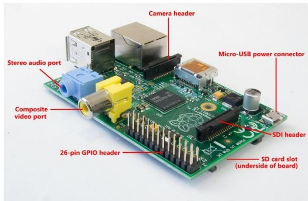
**Gambar 1-6** Port audio stereo Raspberry Pi Model B, port video komposit, konektor GPIO 26-pin, antarmuka tampilan serial (SDI), dan konektor daya Micro-USB. Slot kartu SD berada di bawah konektor layar.
