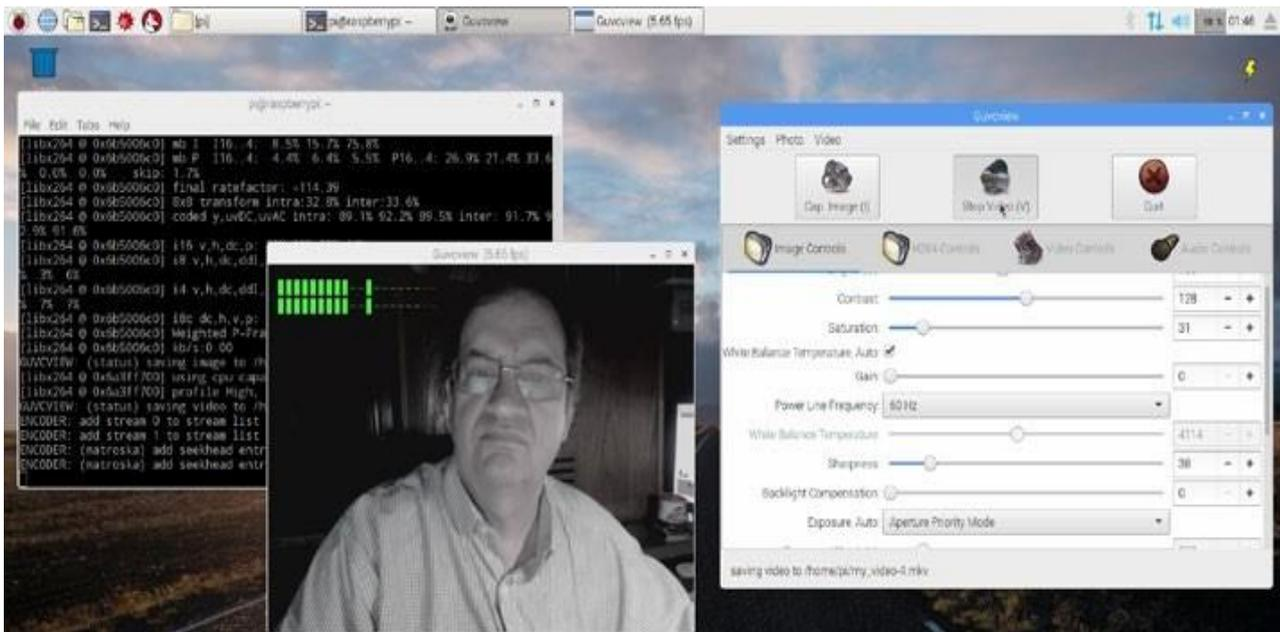
**Gambar 7-20** Saat guvview berjalan, Anda dapat menggunakan panel kontrol (kanan) untuk menyesuaikan pengaturan eksposur, video, dan audio serta mengambil video atau gambar diam. Jendela pratinjau (tengah) menunjukkan pengaturan volume saat merekam video, dan aliran pesan status yang stabil ditampilkan di jendela terminal (kiri).
