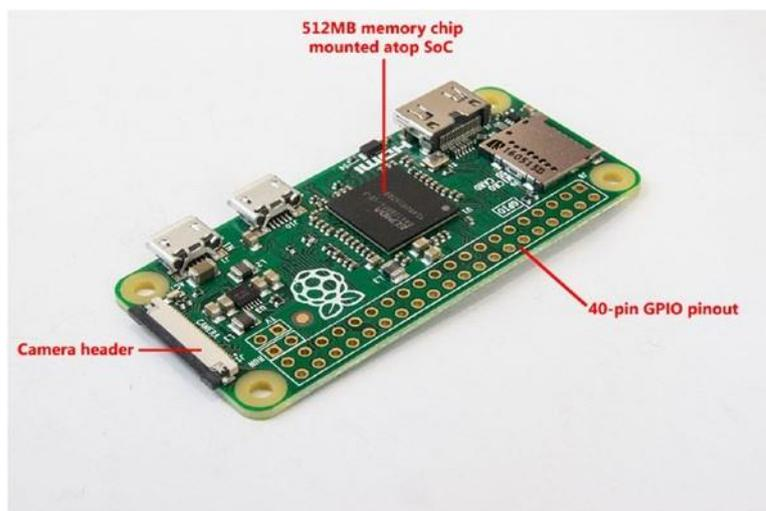
**Gambar 1-12** Port kamera Raspberry Pi Zero dan pinout GPIO 40 lubang
