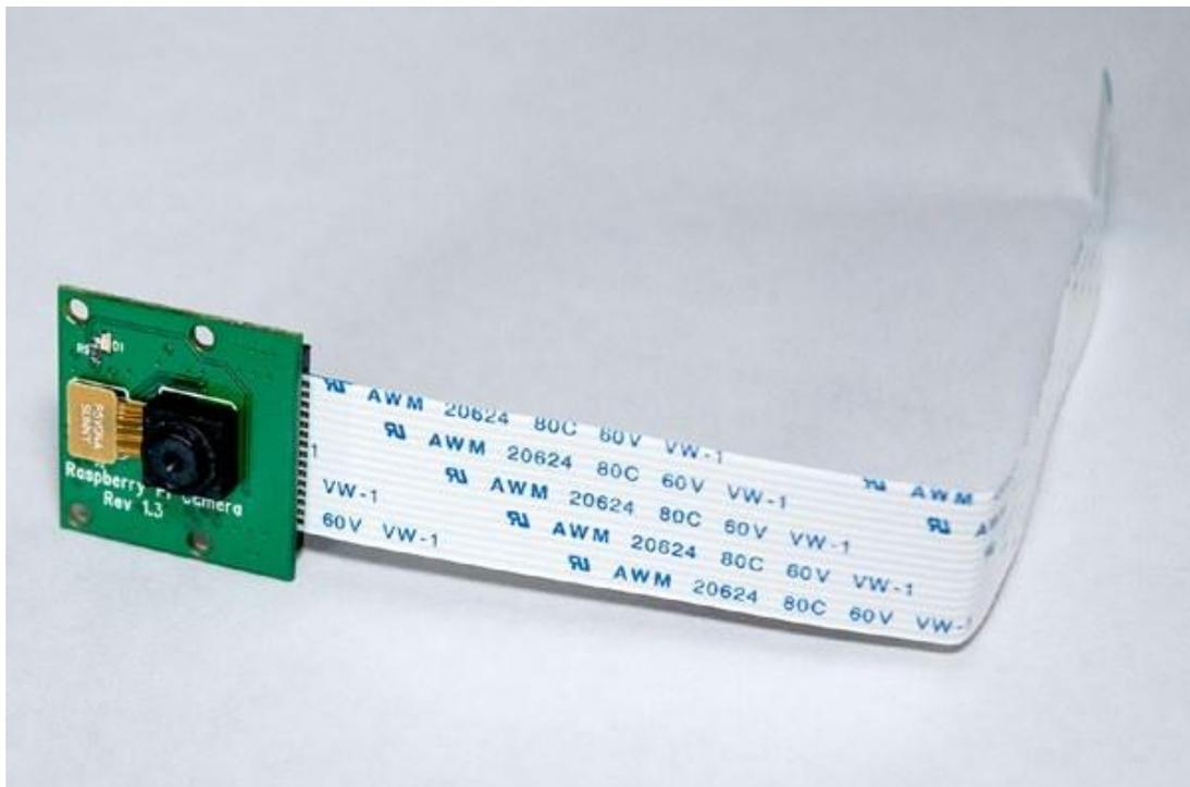
**Gambar 7-1** Kamera Raspberry Pi versi 5MP dengan kabel antarmuka normal terpasang
