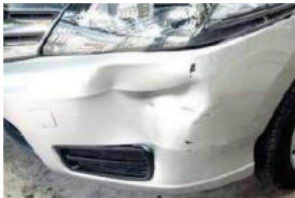
**Gambar 1.3** Gambar bumper mobil penyok
