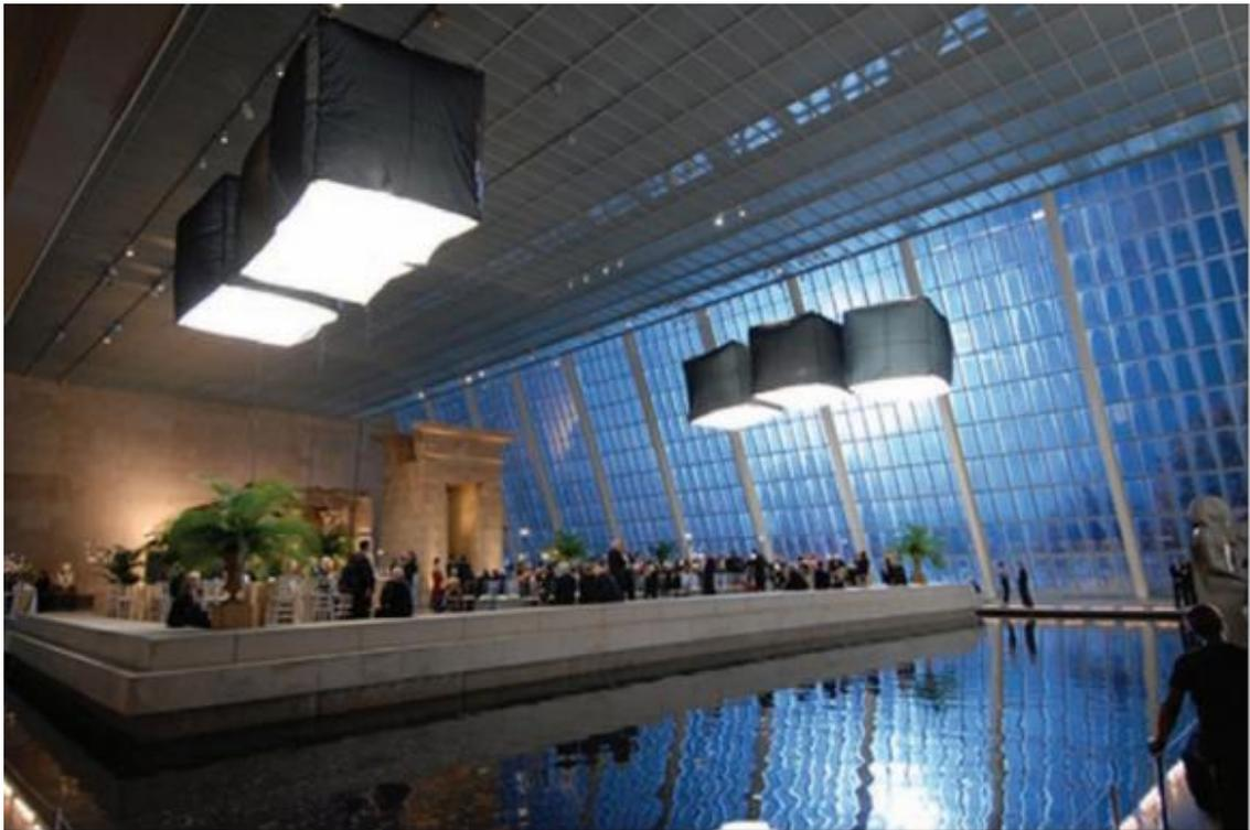
**Gambar 109.** Lampu balon membutuhkan minimal rigging. Museum tidak akan mengizinkan pemasangan jaringan penerangan tugas berat di atas kuil Mesir. Dalam pengaturan ini, balon memiliki rok hitam, yang berisi dan mengontrol tumpahan. (Foto milik Sourcemaker.)
