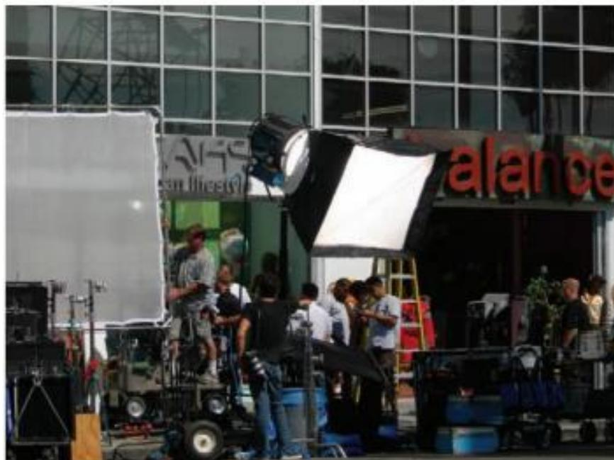
**Gambar 98.** HMI 18K Dengan Softbox Chimera Digunakan Di Lokasi Luar.
