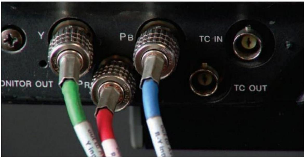
**Gambar 122.** Output komponen pada kamera: Y, Pr, Pb.
