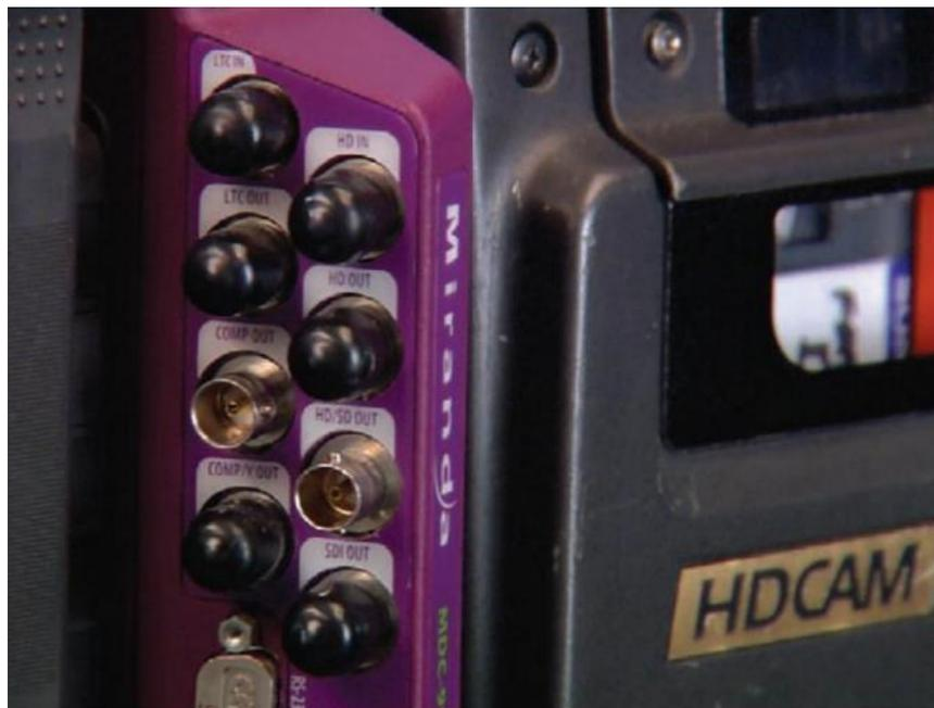
**Gambar 123.** Output HD SDI, Serta Komposit, Kode Waktu, Dan Koneksi Lainnya Pada Verter Downcon Miranda.
