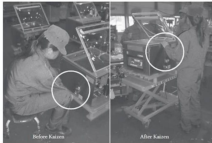
Gambar 9.7 Sebelum dan sesudah Kaizen—modifikasi alat dan keranjang kerja.
