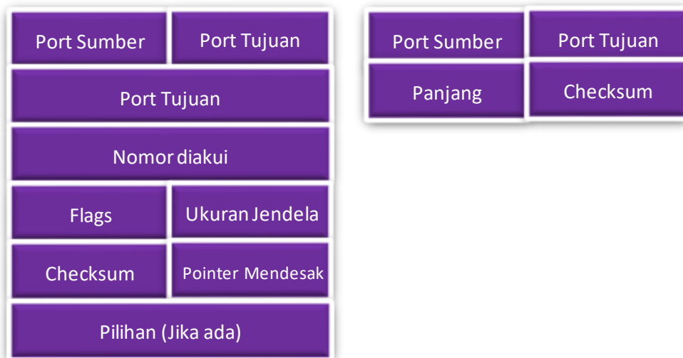
Gambar 5.8 TCP (kiri) versus header datagram UDP (kanan).
