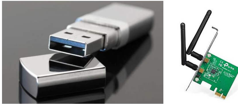
Gambar 4.9 Antarmuka USB nirkabel dan NIC nirkabel.
