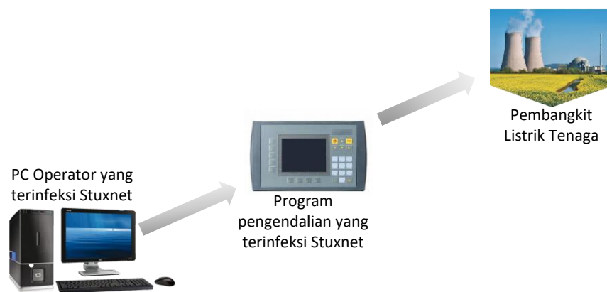
Gambar 1.4 Infiltrasi Stuxnet pada sistem kontrol proses penting melalui PC operator.
