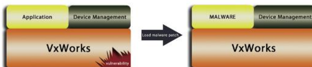
Gambar 2.29 Penyisipan malware ke dalam sistem tertanam melalui port manajemen jarak jauh.
