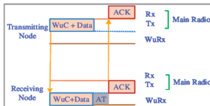
Gambar 11.10. Siklus transmisi data EDT dengan ACK
