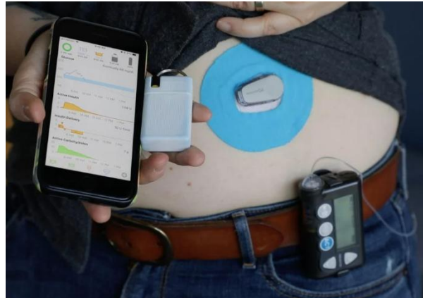
Gambar 3.6. Sistem aplikasi Pankreas Buatan dengan komponen dasar (Tenderich, 2019)
