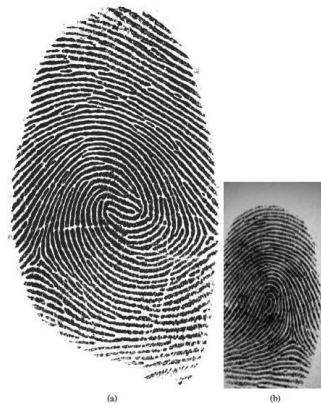
Gambar 1.4 Sidik jari dipindai pada (a) 1000 titik per inci (ppi) dan (b) 500 titik per inci menggunakan sensor sidik jari yang berbeda.
