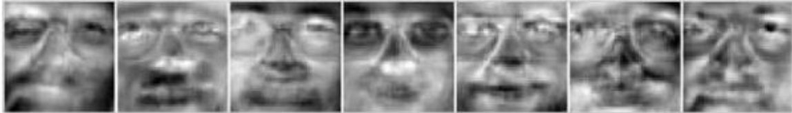
Gambar 3.24 Tujuh Fisherfaces yang sesuai dengan tujuh nilai Eigen terbesar yang diperoleh dari basis data wajah ORL.
