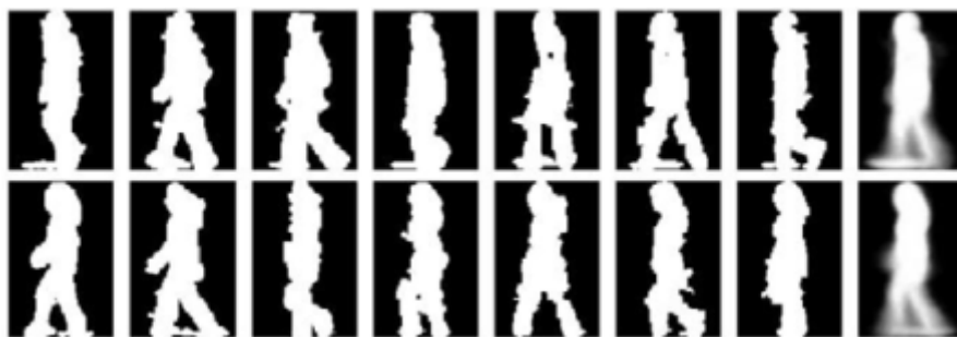
Gambar. 5.7 Contoh yang menunjukkan bingkai siluet yang dinormalkan beserta gambar energi gaya berjalan (GEI). Dua baris tersebut sesuai dengan dua subjek yang berbeda. Di setiap baris, 7 bingkai digunakan untuk memperoleh GEI yang merupakan gambar paling kanan.
