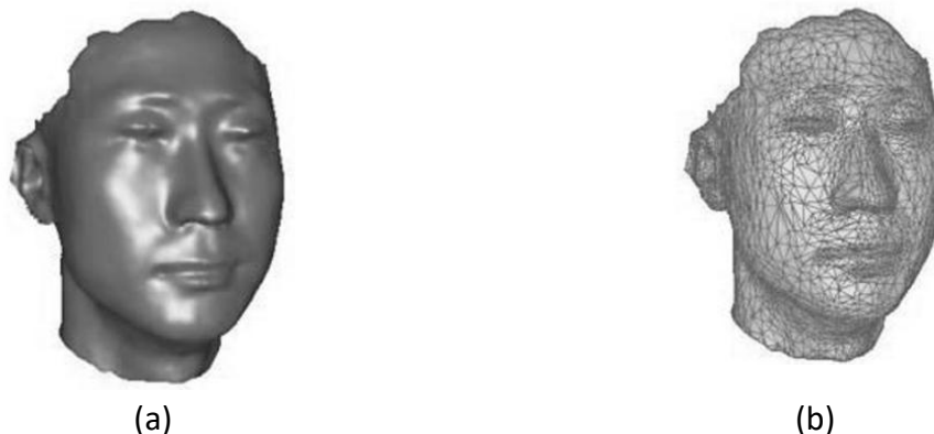
Gambar 3.12 (a) Model 3D penuh wajah manusia yang diperoleh menggunakan sensor 3D. (b) Model wajah 3D yang direpresentasikan menggunakan jaring segitiga.
