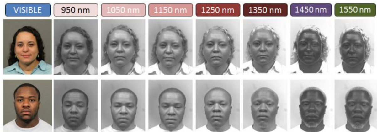
Gambar 3.8 Gambar wajah yang ditangkap dalam spektrum tampak dan inframerah dekat pada panjang gelombang yang berbeda.
