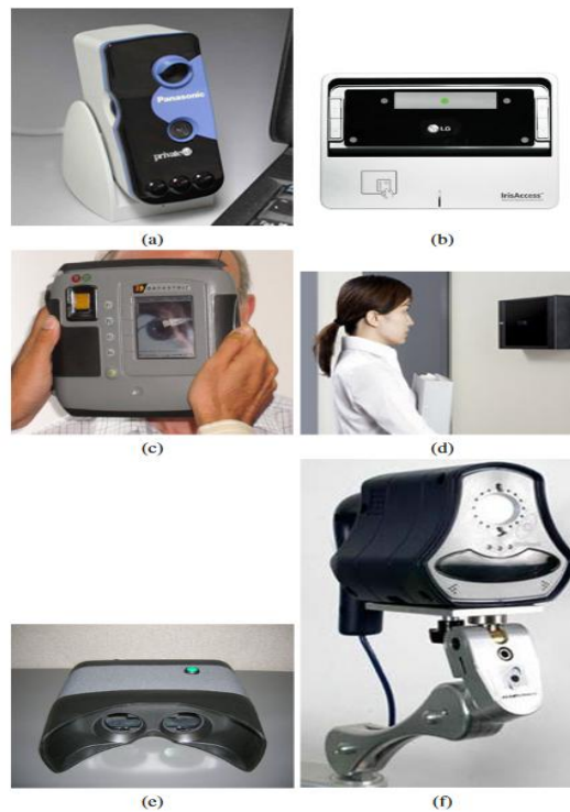
Gambar 4.7 Contoh perangkat akuisisi citra iris yang dikomersialkan.
