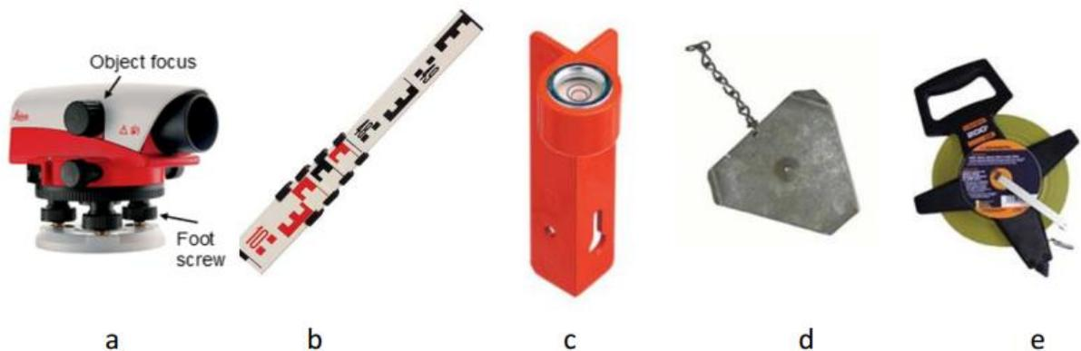
Gambar 2.8 Perlatan leveling. (a) Level otomatis Leica, (b) Tongkat leveling 5m, (c) Tongkat "gelembung", (d) Plat pengganti, (e) Pita pengukur.
