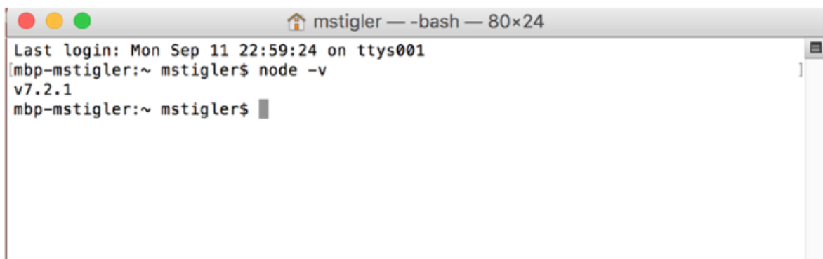
Gambar 2.10 Perintah Terminal Ini Mengonfirmasi Bahwa Saya Telah Menginstal Node. Tanda -v Menandakan Versi, Jadi Respons Yang Ditampilkan Adalah Versi Node Yang Telah Saya Instal.
