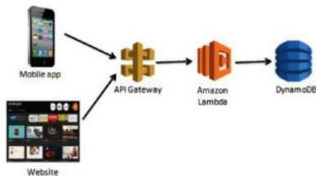
Gambar 1.1. Permintaan dibuat ke API Gateway, yang kemudian memicu fungsi Lambda untuk memberikan respons
