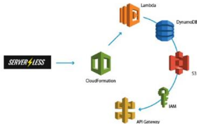
Gambar 1.11. Gambar ini menunjukkan cara Serverless menerapkan aplikasi menggunakan CloudFormation, yang kemudian membangun layanan lainnya dalam proyek yang dikonfigurasi
