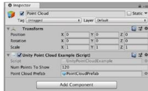
Gambar 3.39 Set Pointcloudprefab Sebagai Point Cloud Prefab
