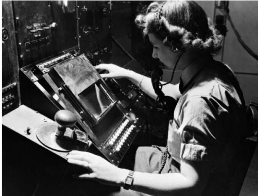
Gambar 1.3 Contoh antarmuka komputer awal untuk pemetaan ulang proprioseptif; operator radar WAAF Denise Miley sedang memetakan pesawat di Ruang Penerima di stasiun "Chain Home" Bawdsey pada bulan Mei 1945 (perhatikan kenop besar di sebelah kirinya, sebuah kontrol goniometer yang memungkinkan Miley mengubah sensitivitas pencari arah radio)
