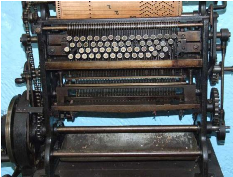
Gambar 1.2 Pemotong Kartu Jacquard Masson Mills WTM 10, 1783, yang digunakan untuk membuat kartu berlubang yang dibaca oleh alat tenun Jacquard
