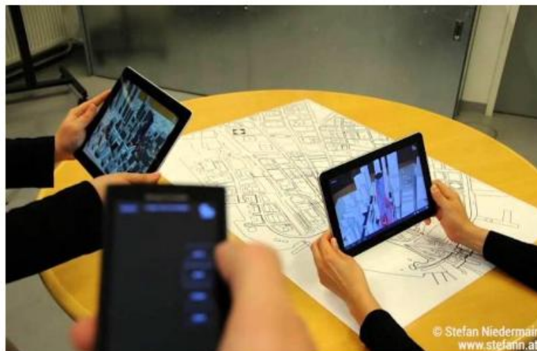
Gambar 5.19. Aplikasi ini menggunakan gambar cetak yang digunakan semua perangkat untuk relokasi guna berbagi koordinat
