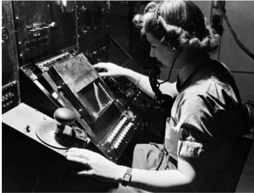
Gambar 1.3 Contoh antarmuka komputer awal untuk pemetaan ulang proprioseptif; operator radar WAAF Denise Miley sedang memetakan pesawat di Ruang Penerima di stasiun "Chain Home" Bawdsey pada bulan Mei 1945 (perhatikan kenop besar di sebelah kirinya, sebuah kontrol goniometer yang memungkinkan Miley mengubah sensitivitas pencari arah radio)
