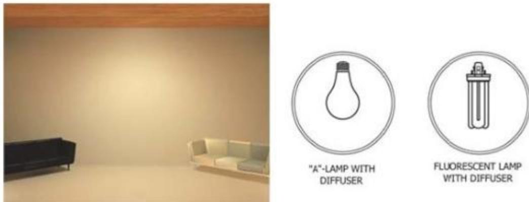
**Gambar 4.8 Efek Cahaya Yang Sangat Menyebar (Kiri) Sering Kali Merupakan Hasil Dari Luminer Dengan Diffuser Dan Sumber Cahaya Yang Menyebar (Kanan).**
