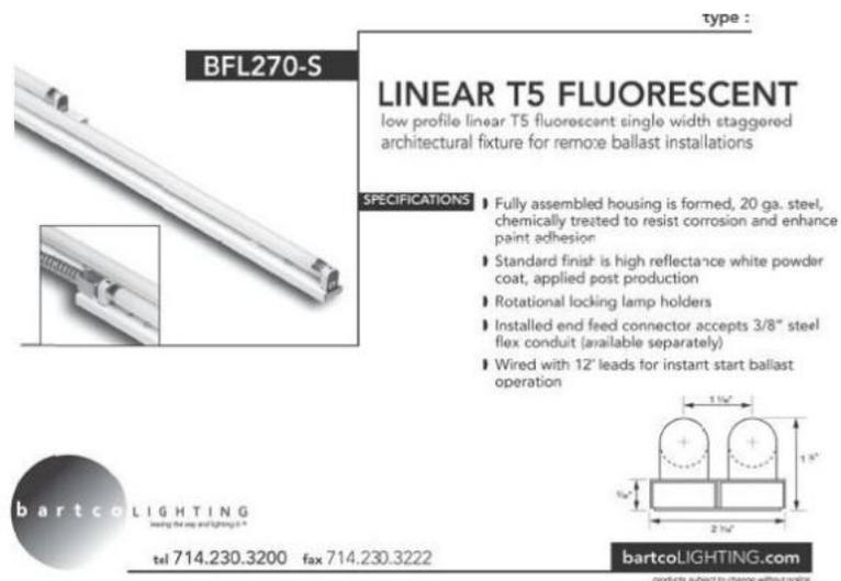
**Gambar 9.42 Strip Lampu Fluoresen Linier Yang Disusun Bertingkat Dari Bartco**
