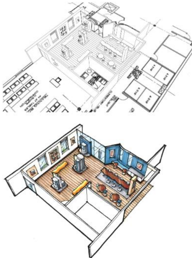
Gambar 8.64 Model Yang Dibuat Dari Rencana Autocad Yang Diimpor; Model Yang Dicetak Digambar Dengan Tangan Menggunakan Pena Dan Spidol
