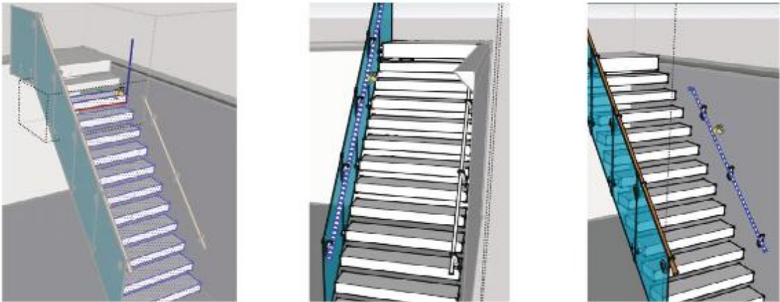
Gambar 6.72 Ganti Warna Tangga Dan Pegangan Tangan Komponen Dengan Warna Cat Default SketchUp
