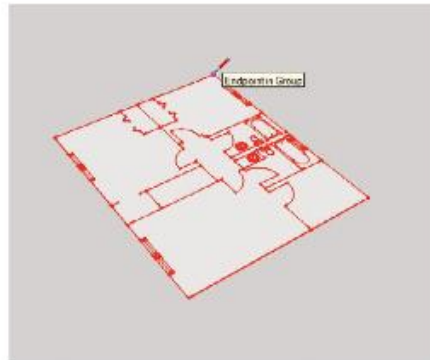
Gambar 6.21 Buat Garis Keliling Untuk Merekonstruksi Permukaan Lantai Yang Rusak
