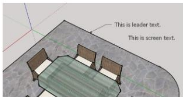
Gambar 8.10 Teks Pemimpin Dilampirkan Ke Model Dengan Garis Pemimpin. Teks Layar Adalah Catatan Yang Ditempatkan Di Mana Saja
