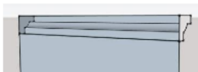
Gambar 6.53 Follow Me Mengekstruksi Permukaan Di Belakangnya. Klik Ctrl Tepat Sebelum Mengekstruksi Agar Permukaan Tetap Utuh
