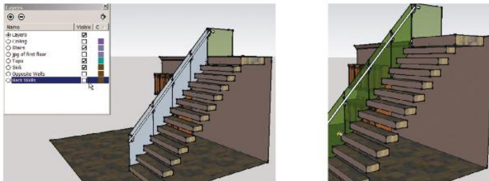
Gambar 7.18 Matikan Lapisan Dinding Belakang, Agar Pekerjaan Di Ruang Sempit Menjadi Lebih Mudah
