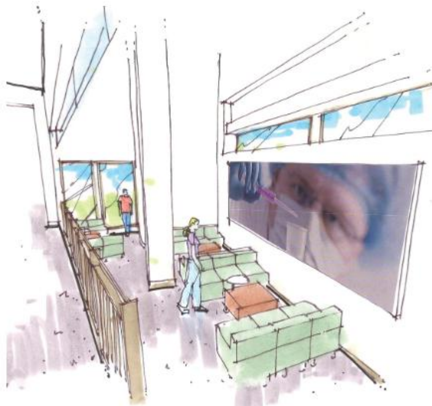
Gambar 8.63 Model Yang Dicetak Pada Kertas Bond, Kemudian Dijiplak Dan Digambar Dengan Tangan Menggunakan Pena Dan Spidol. Gambar Yang Diimpor Digunakan Sebagai Seni Dinding.
