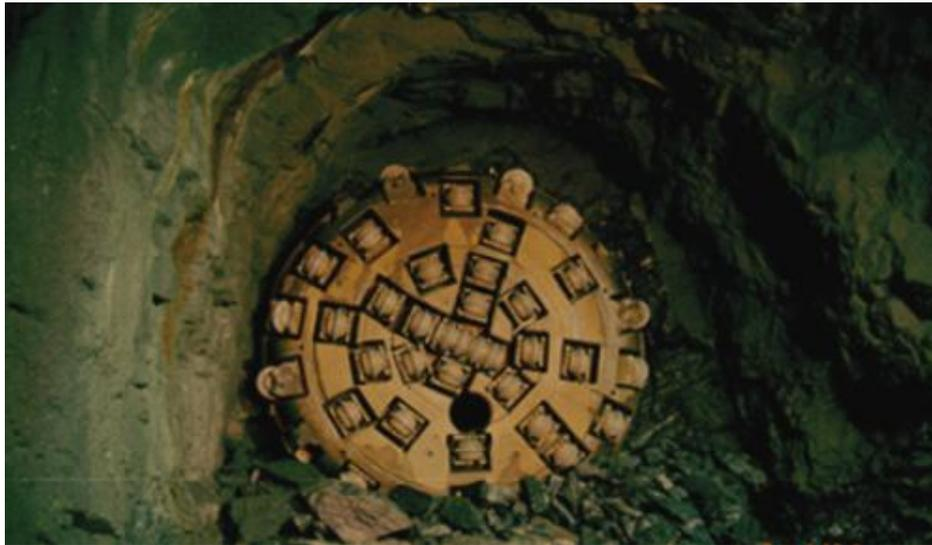
**Gambar 6.3 Kepala Pemotong Mesin Bor Terowongan Batu Yang Digunakan Untuk Menggali Terowongan Chattahoochee. Pemotong Cakram Memotong Alur Dengan Jarak Sekitar 4 Inchi Dalam Contoh Ini. Sumber: E.J. Cording.**
