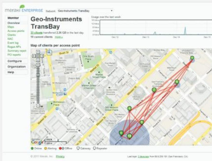
**Gambar 6.C Jaringan Nirkabel Proyek TTC Untuk Data Langsung Dan Transmisi Gambar Konstruksi. Total Station Otomatis, Ditunjukkan Dengan Warna Hijau Digunakan Sebagai Node Nirkabel Untuk Jaringan Nirkabel Proyek Khusus. Dirancang Dan Diimplementasikan Oleh Arup North America Ltd. Untuk Transbay Joint Powers Authority, San Francisco, California.**
