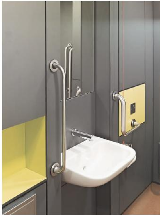
Gambar 17.7 Toilet Untuk Penyandang Cacat Pegangan Tangan Terlihat Terpasang Di Kedua Sisi Wastafel, Yang Memiliki Keran Berventilasi Yang Dioperasikan Dengan Sensor.
