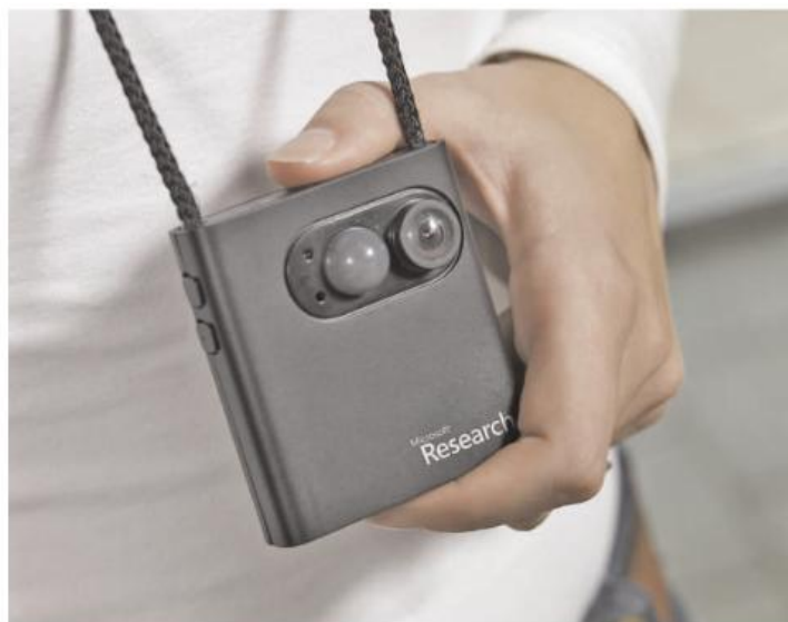
Gambar 7.2 Sensecam Mengambil Gambar Dan Pengukuran Variabel Fisik Secara Berkala. Posisi dan tingkat aktivitas
