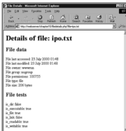
Gambar 7.4 Tampilan Detail File memperlihatkan informasi sistem file tentang suatu file. Perhatikan bahwa izin diperlihatkan dalam format oktal.
