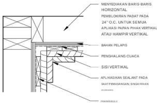
SAMBUNGAN PAPAN SUDUT DALAM
