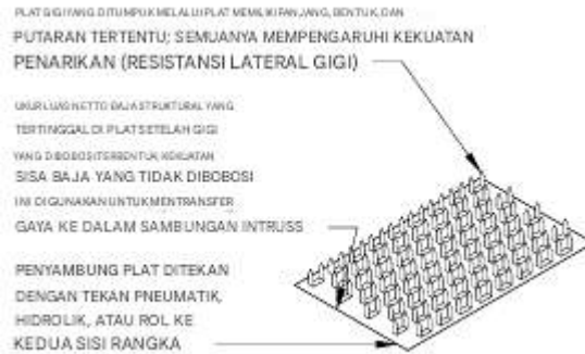
Gambar 2.150 Konektor plat logam umum
