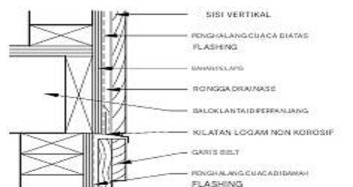
Gambar 2.289 Sambungan sabuk
