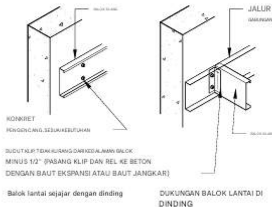
Gambar 2.44 Balok lantai pada dinding yang bersambung
