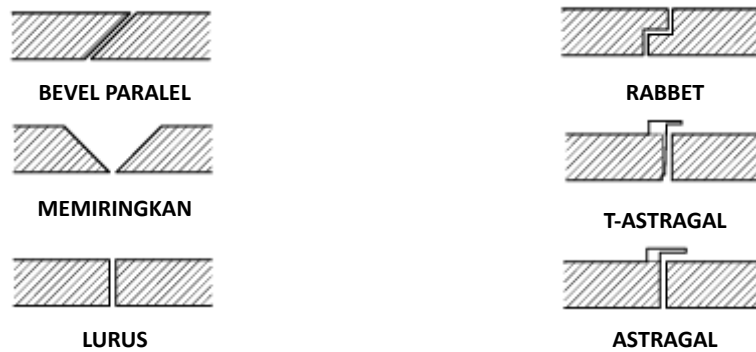
Gambar 3.8 Jenis tepi pertemuan untuk daun pintu ganda
