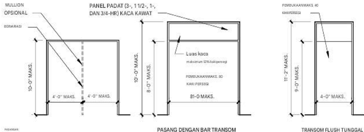
Gambar 3.46 Tinggi rangka baja dengan peringkat tahan api
