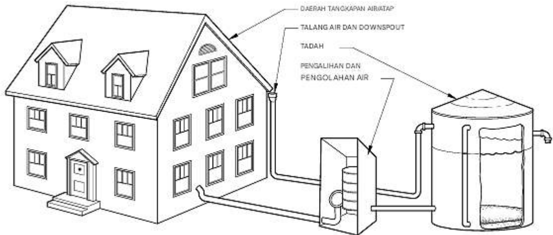
Gambar 4.47 Sistem pemanenan air hujan—komponen utama
