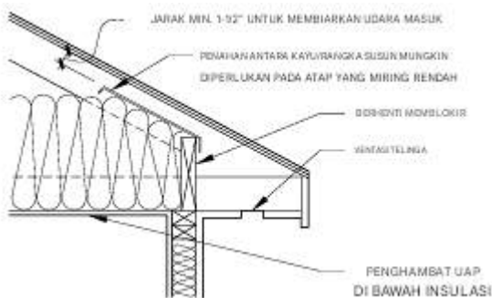
Gambar 2.200 Penutup dan penahan isolasi
