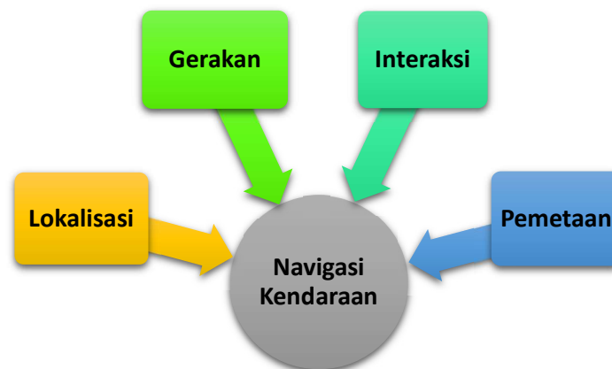
Gambar 2.5 Fungsi navigasi fundamental.
