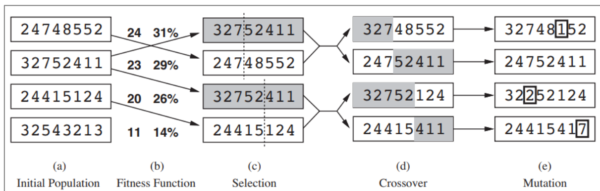
Gambar 4.6 Algoritma genetik, diilustrasikan untuk rangkaian digit yang mewakili status 8 ratu. Populasi awal pada (a) diurutkan berdasarkan fungsi kebugaran pada (b), menghasilkan
