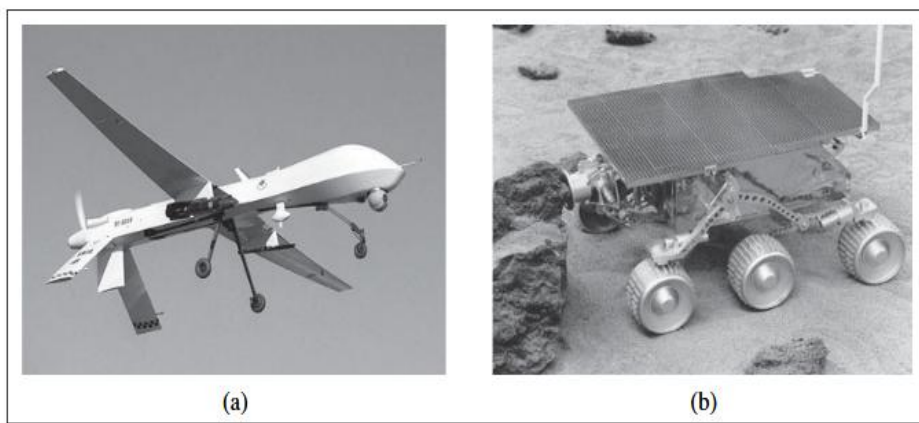
Gambar 7.2 (a) Predator, wahana udara nirawak (UAV) yang digunakan oleh Militer AS. Gambar milik General Atomics Aeronautical Systems. (b) Sojourner milik NASA, robot bergerak yang menjelajahi permukaan Mars pada Juli 1997.
