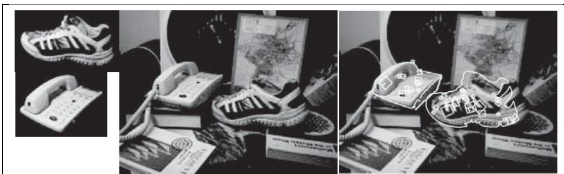
Gambar 6.15 Contoh lain pengenalan objek, yang satu ini menggunakan fitur SIFT (Scale Invariant Feature Transform), versi sebelumnya dari fitur HOG. Di sebelah kiri , gambar sepatu dan telepon yang berfungsi sebagai model objek. Di tengah , gambar uji. Di sebelah kanan , sepatu dan telepon telah dideteksi dengan: menemukan titik-titik pada gambar yang deskripsi fitur SIFT-nya cocok dengan suatu model; menghitung estimasi pose model; dan memverifikasi estimasi tersebut. Kecocokan yang kuat biasanya diverifikasi dengan positif palsu yang jarang terjadi.
