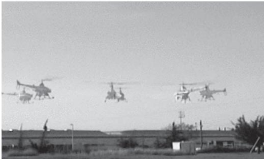
Gambar 3.10 Gambar time-lapse tumpang tindih dari sebuah helikopter otonom yang melakukan manuver "nose-in-circle" yang sangat sulit. Helikopter tersebut berada di bawah kendali kebijakan yang dikembangkan oleh algoritma pencarian kebijakan PEGASUS. Sebuah model simulator dikembangkan dengan mengamati efek berbagai manipulasi kendali pada helikopter sungguhan; kemudian algoritma tersebut dijalankan pada model simulator semalaman. Berbagai pengontrol dikembangkan untuk berbagai manuver. Dalam semua kasus, kinerjanya jauh melampaui kinerja pilot manusia ahli yang menggunakan kendali jarak jauh.
