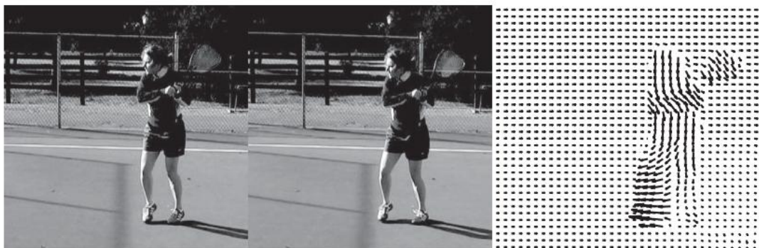
Gambar 6.10 Dua frame dari rangkaian video. Di sebelah kanan adalah medan aliran optik yang sesuai dengan perpindahan dari satu frame ke frame lainnya. Perhatikan bagaimana pergerakan raket tenis dan kaki depan ditangkap oleh arah panah.
