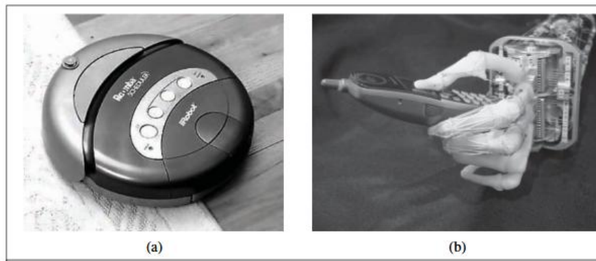
Gambar 7.30 (a) Roomba, robot bergerak terlaris di dunia, sedang menyedot debu lantai. Gambar milik iRobot, © 2009. (b) Tangan robot yang dimodelkan menyerupai tangan manusia. Gambar milik University of Washington dan Carnegie Mellon University.
