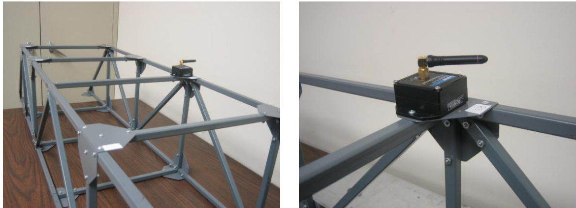
Gambar 1.14: Sensor nirkabel yang digunakan pada struktur grid laboratorium.
