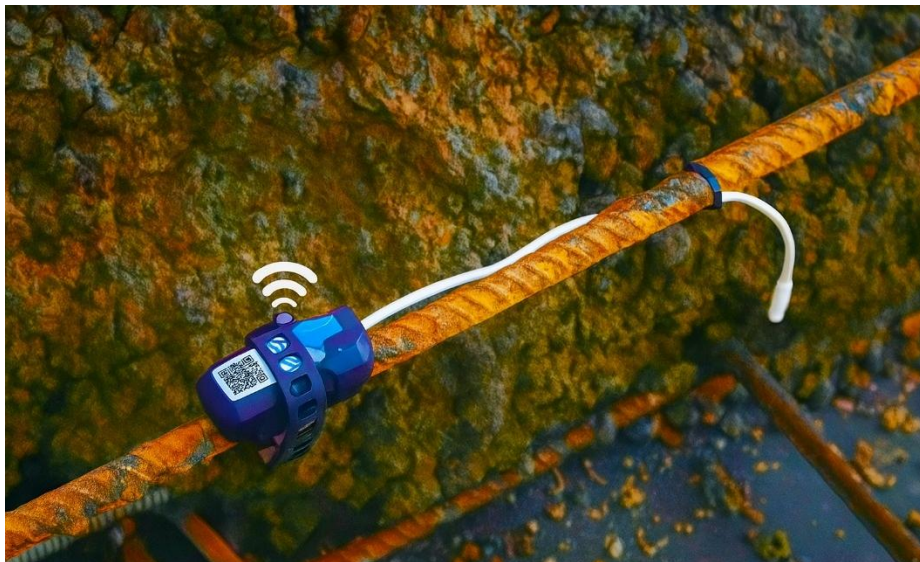
Gambar 11.1: Sensor IoT yang tertanam pada beton digunakan untuk memantau suhu dan kekuatan in situ.
