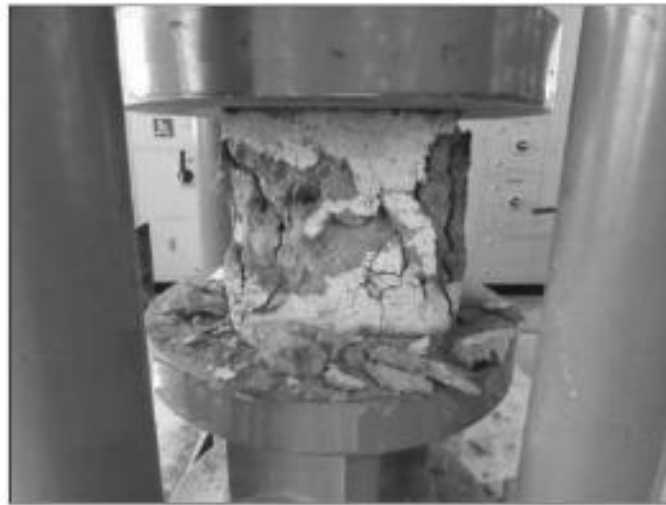
Gambar 6.5: Uji kuat tekan pada kubus beton berukuran 150 × 150 × 150.
