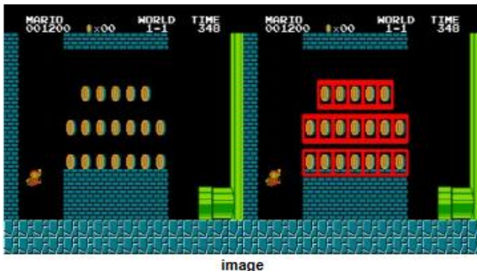
Gambar14. Lokasi template yang cocok ditandai dengan kotak merah
