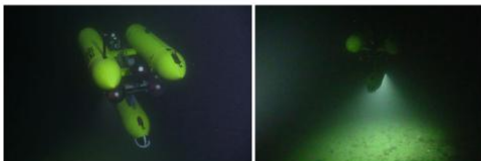
Gambar 11.1 AUV Anton GEOMAR beroperasi di kedalaman 100 m di terumbu karang Tisler, Norwegia. Untuk memetakan dasar laut secara visual (gambar kanan), AUV harus tetap dekat
