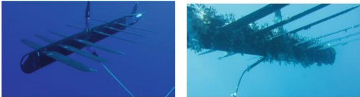
Gambar 4.2 Gambar bawah menunjukkan Wave Glider® MARUM yang terkontaminasi teritip leher angsa Atlantik Pollicipes pollicipes .
