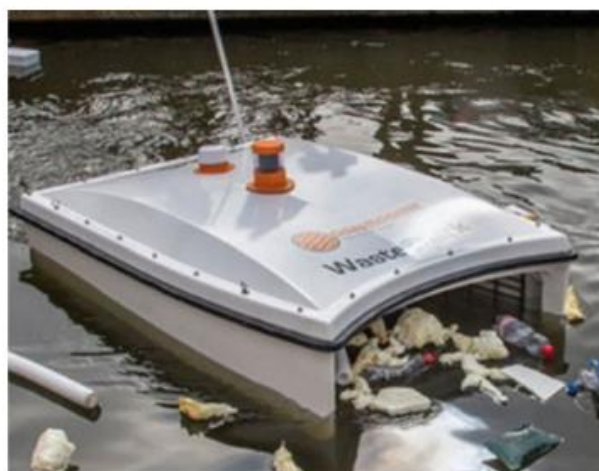
Gambar 1.2 Hiu Sampah. Sebuah studi tentang robot otonom untuk mengumpulkan sampah terapung di pelabuhan dan lingkungan maritim terbatas lainnya.
