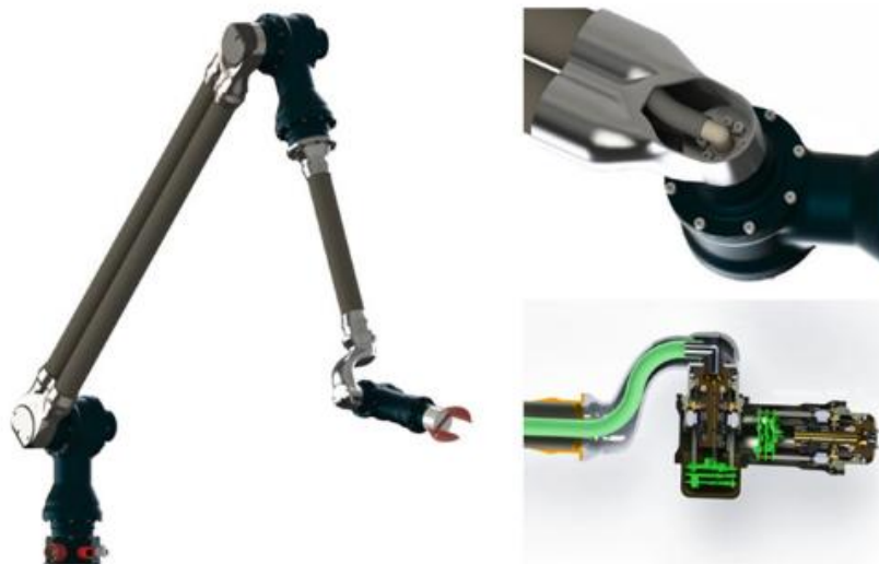
Gambar. 8.3 Manipulator DOF yang terdiri dari tiga PTU
