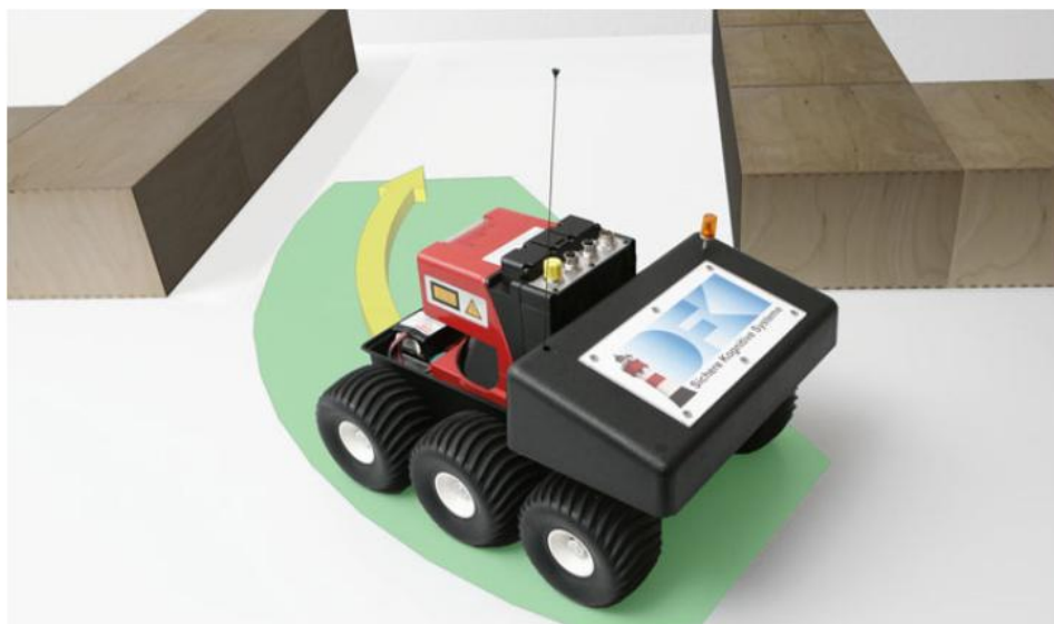
Gambar 15.3 Demonstran SAMS yang sedang melaju di tikungan kanan dan zona aman bebas tabrakan pada pergerakan tersebut. Jika terdapat halangan di dalam zona aman, AGV akan berhenti. Masukan ke algoritma adalah kecepatan dan kecepatan sudut (panah kuning), yang ditentukan dengan interval ketidakpastian. Keluaran adalah zona aman (hijau) sebagai array jarak ke berbagai arah relatif terhadap kendaraan.
