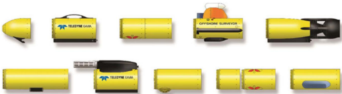
Gambar 5.2 Dua opsi konfigurasi yang berbeda untuk AUV Gavia dari Teledyne. Setiap segmen lambung berisi komponen fungsional individual dan dilengkapi dengan antarmuka elektromekanisnya. Gambar milik Teledyne-Gavia
