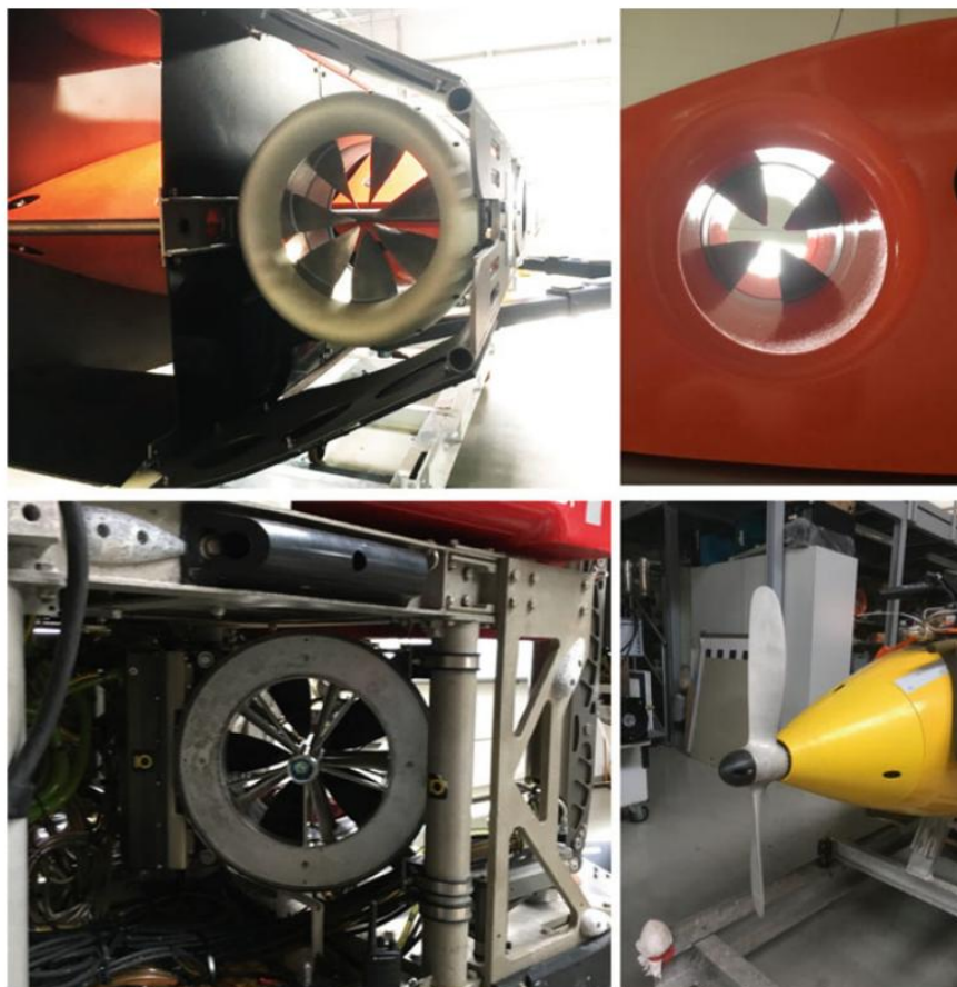
Gambar 6.1 Contoh sistem propulsi bawah air. Baris atas: pendorong tanpa hub berpenggerak pelek. Gambar kiri: pendorong propulsi utama (Diameter dalam: 266 mm). Gambar kanan: Konfigurasi pendorong terowongan (Diameter dalam: 160 mm). Baris bawah:
