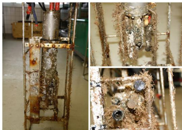
Gambar 2.11. Unit sensor CTD setelah 8 bulan paparan di perairan dangkal produktif di Laut Utara bagian selatan
