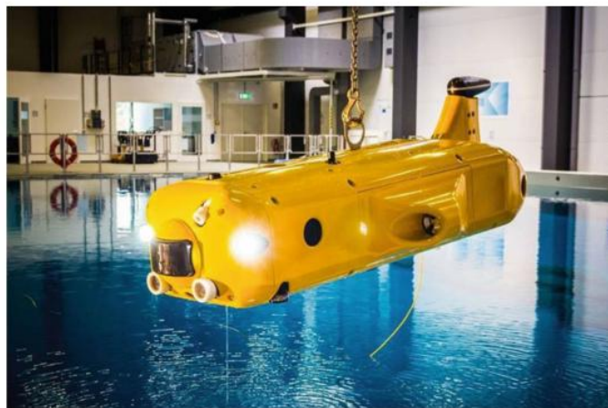
Gambar 1.4 Kendaraan otonom bawah air Flatfish yang dirancang dan dibangun dalam proyek kerja sama dengan DFKI Bremen dan SENAI-Salvador, Brasil.
