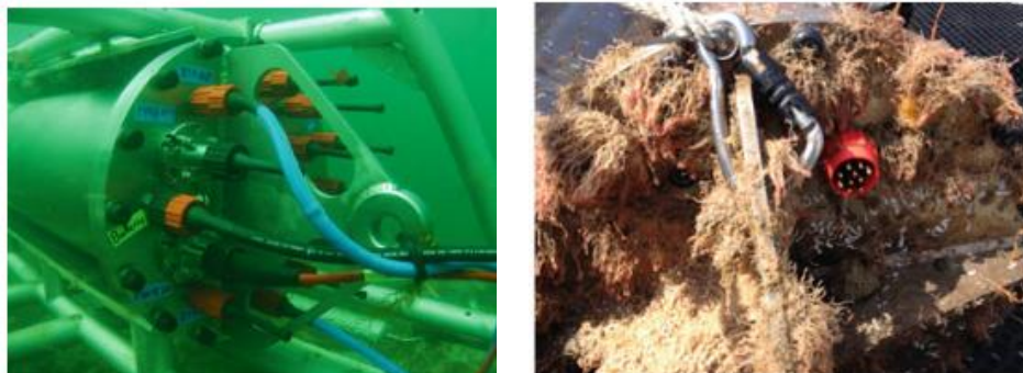
Gambar 2.10. Elemen inti sistem simpul bawah air sesaat setelah paparan (gambar kiri) dan setelah 8 bulan di bawah air (gambar kanan)
