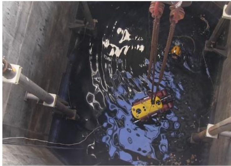
Gambar 14.1. Contoh misi di lingkungan bawah air yang terbatas. AUV Dagon sedang diturunkan ke dalam poros air pendingin pembangkit listrik. Gambar milik Marc Hildebrandt, DFKI
