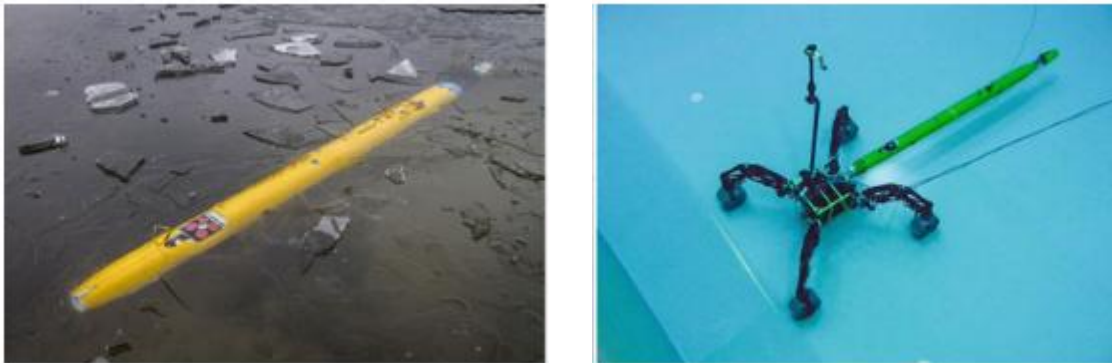
Gambar 1.7 Robot Bawah Air Leng. Sistem ini sebenarnya merupakan studi untuk menjelajahi kedalaman samudra luar angkasa (studi untuk Badan Antariksa Jerman), tetapi telah digunakan di sini untuk mensimulasikan skenario multi-robot. Gambar di sebelah kanan menunjukkan robot Leng sedang berlabuh ke robot Sherpa-UW dalam upaya bertukar data dalam jumlah besar, yang tidak efisien jika dilakukan melalui tautan radio di dalam air.
