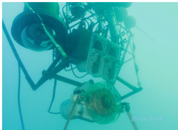
Gambar. 2.7 Observatorium stereoskopik bawah air RemOs1 untuk mengukur kelimpahan ikan, komposisi spesies, dan distribusi frekuensi panjang ikan
