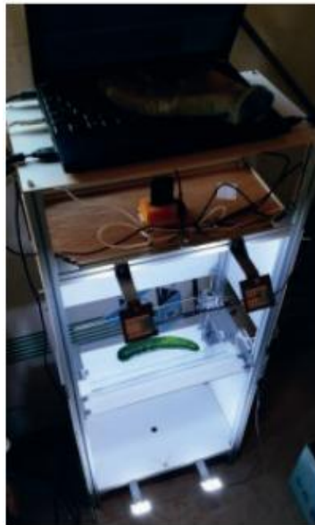
Gambar 4.20 Bagian dari mesin sortir mentimun akhir, tempat kamera mengambil gambar mentimun dan komputer menguraikan prediksi, sebelum menggerakkan mentimun ke depan, dan meletakkannya di ember yang tepat.
