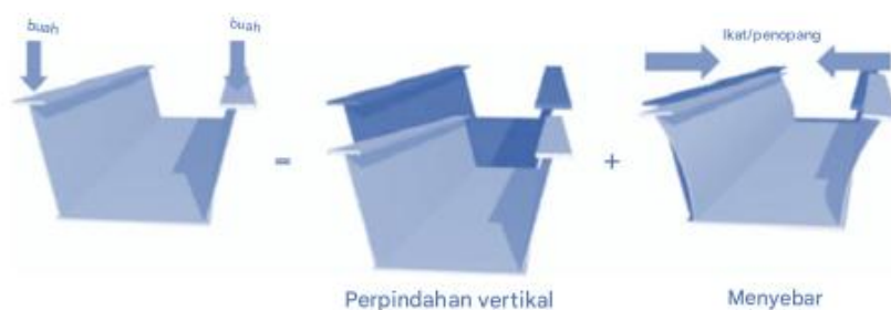
Gambar 5.9 Efek lentur dan sebaran pada penampang kotak trapesium terbuka tanpa penguat.
