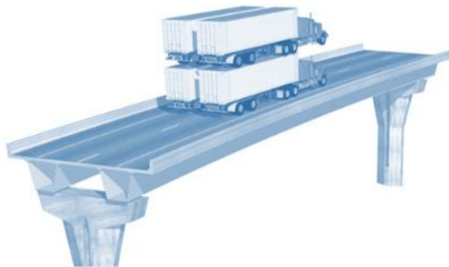
Gambar 5.18 Pemuatan yang diusulkan oleh NCHRP 406 untuk evaluasi redundansi sistem dan kapasitas cadangan (kelipatan pasangan HS-20).
