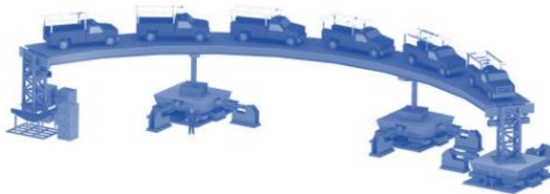
Gambar 6.18 Tampilan 3D model jembatan lengkung di atas meja goyang (truk yang digunakan untuk uji beban hidup juga ditampilkan).
