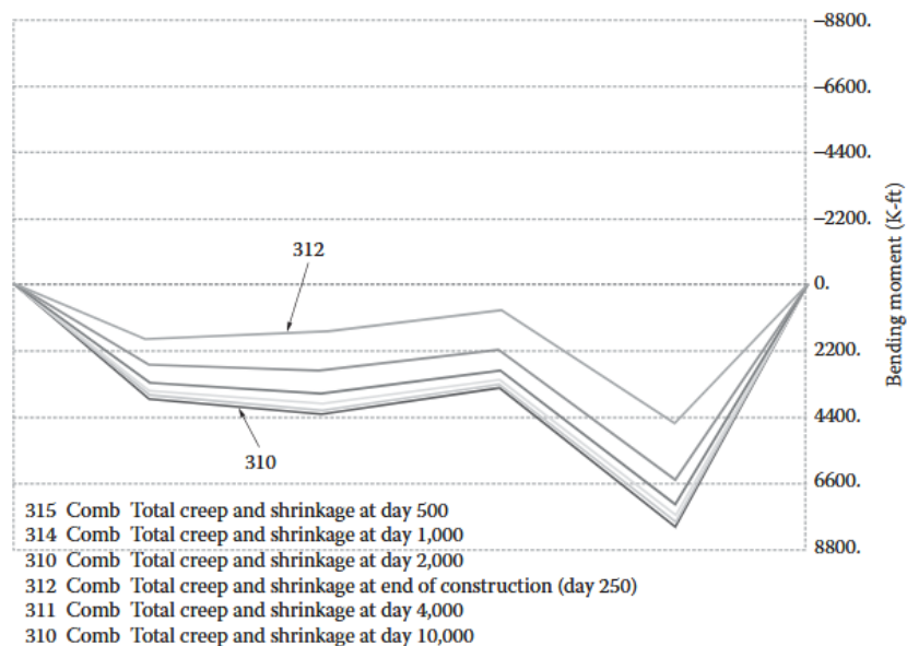
Gambar 3.65 Perkembangan Momen Lentur Bergantung Waktu Akibat Rangkak Dan Susut Dari Akhir Konstruksi (Diagram 312) Hingga Hari Ke-10.000 (Diagram 310).
