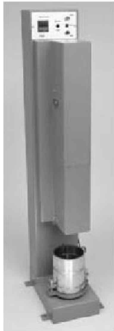
Gambar 4.3 Uji Standard Proctor menggunakan pemadat mekanis
