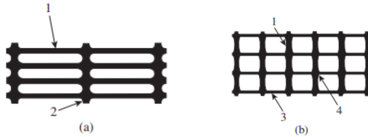
Gambar 13.9 Geogrid: (A) Uniaksial; (B) Biaksial (Catatan: 1—Tulang Rusuk Memanjang; 2—Batang Melintang; 3—Tulang Rusuk Melintang; 4—Sambungan)
