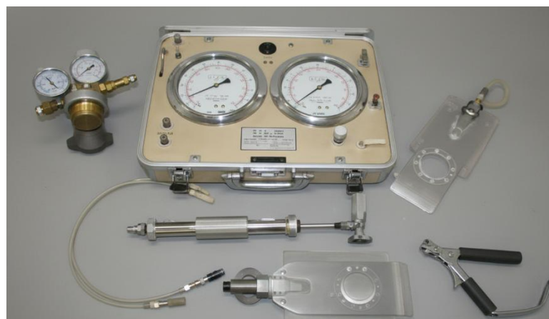
Gambar 10.23 Perakitan peralatan untuk uji dilatometer.
