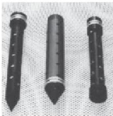
Gambar 10.9 Komponen-komponen piezometer tipe Casagrande.
