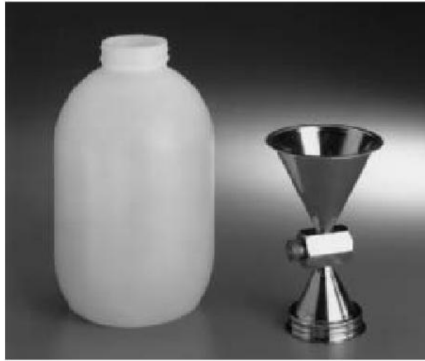
Gambar 4.16 Stoples plastik dan kerucut logam untuk alat kerucut pasir (Catatan: Stoples diisi dengan pasir Ottawa.)
