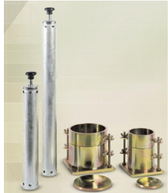
Gambar 4.8 Perbandingan palu Proctor standar (kiri) dan yang dimodifikasi (kanan)
