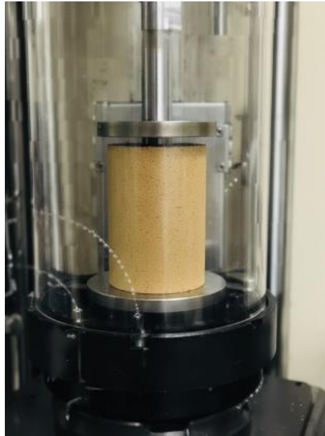
Gambar 8.13 Spesimen tanah triaksial pada saat kegagalan selama uji konsolidasi-drainase
