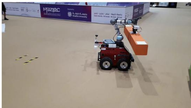
Gambar 7.1 Robot layanan untuk konstruksi dan transportasi batu bata
