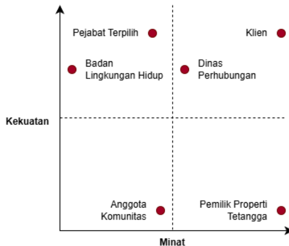
Gambar 10.4 Contoh Grid Kekuatan-Kepentingan Untuk Proyek Infrastruktur Sipil.
